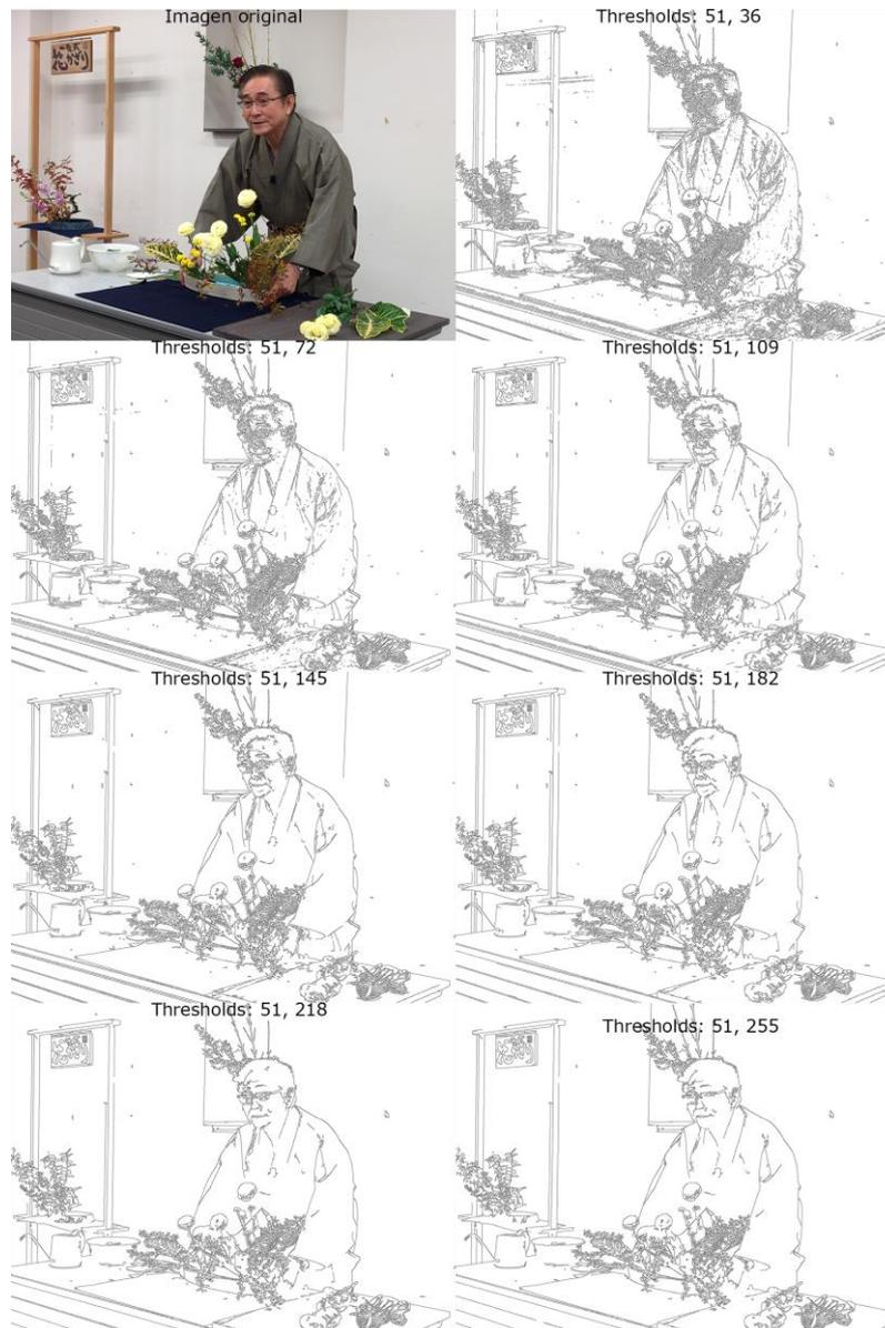
Figura 8: Ejemplo de barrido de umbral en la función Canny
