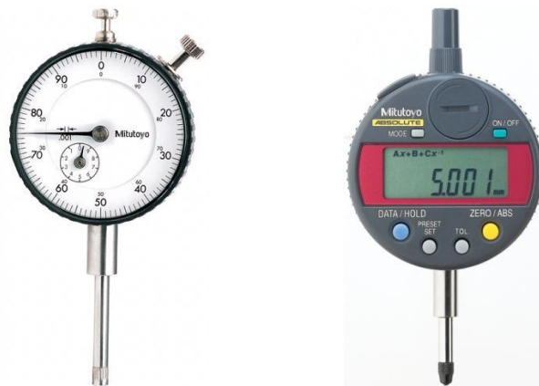
Figura 5-1 Indicador de carátula análogo y digital Mitutoyo. (Catálogo Travers Tool, Flushing, New York)
