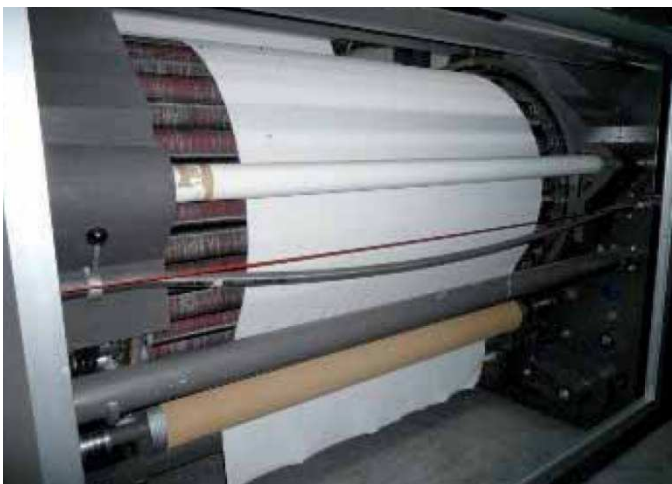
Figura 3: A la izquierda imagen de una percha trabajando. A la derecha esquema de la disposición de los rodillos recubiertos de una guarnición de púas que hacen levantar el pelo.
