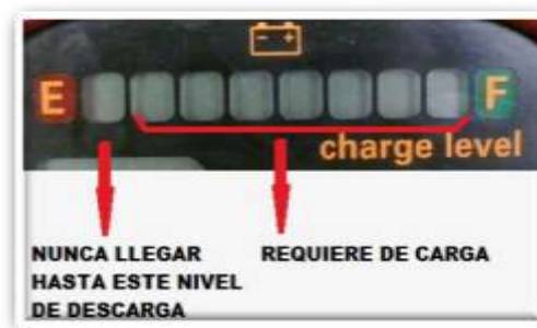
FIGURA 18: INDICADOR DE NIVEL DE BATERIA
