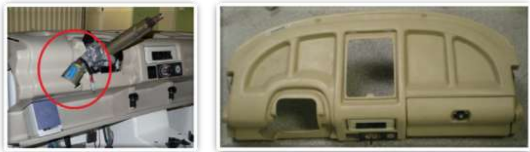
FIGURA 93: DAÑOS EN SALPICADERO ACTUAL
