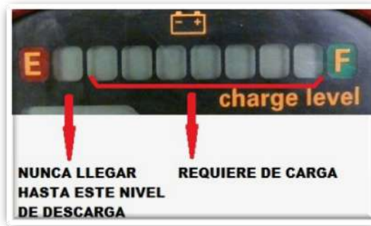
FIGURA 30: INDICADOR DE NIVEL DE BATERIA
