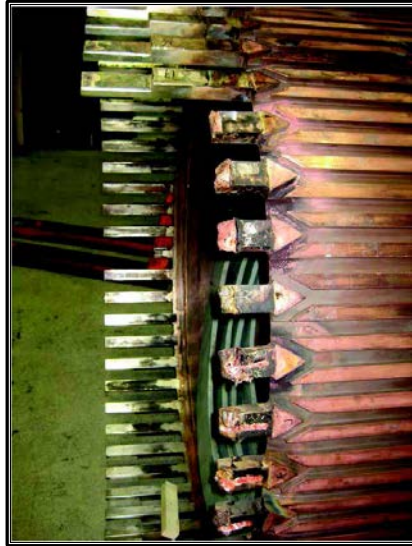
Fig. 3. Jaula de amortiguación; 14 barras amortiguadoras rotas.
