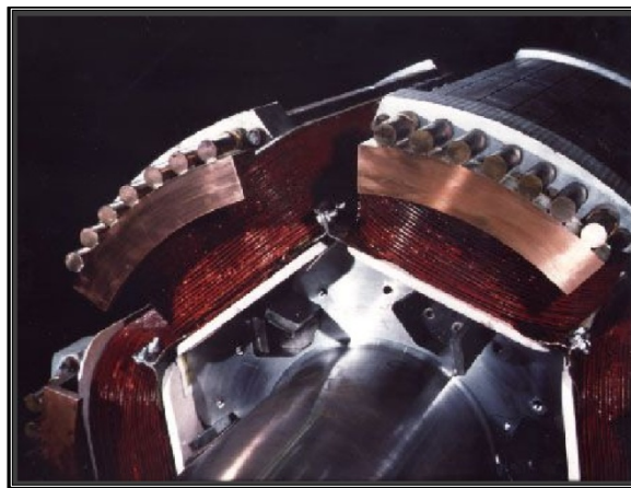
Fig. 1. Devanado amortiguador de un motor síncrono de polos salientes. (Fuente: Internet)
