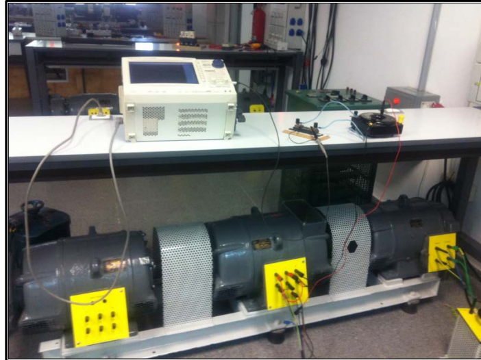
Fig. 21. Motores y osciloscopio empleados en los ensayos
