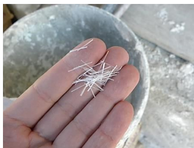
Figura 15: Refuerzo de fibra de vidrio, amasado con yeso para el refuerzo de la bóveda.
