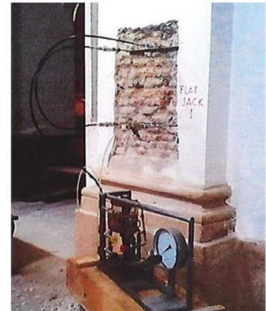
Figura 22: Disposición de la prueba Flatjack Doble.
