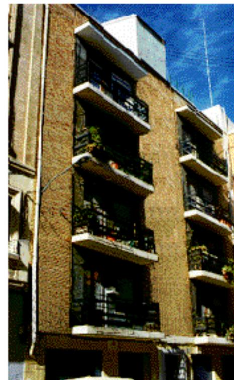
El ladrillo de la fábrica es de color paja manchado con rojo, con los tendeles acusados y las llagas a hueso. Las dos bandas que quedan entre la fábrica cara vista, en las que se alojan los balcones del edificio, aparecen tratadas con granulite.
