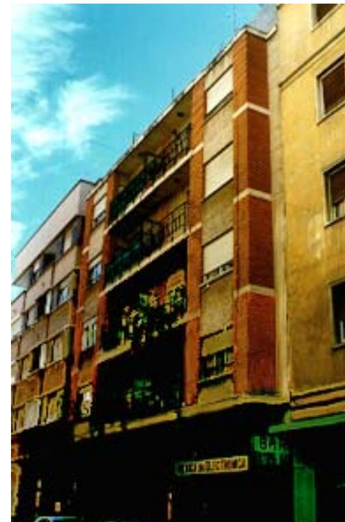
La fábrica se ve interrumpida por la línea de imposta de cada forjado y ocupa los dos cuerpos volados formando sus cantoneras, así como en el centro del plano de la fachada. Coincidiendo con la separación de solanas se forma una banda de tres pies de anchura. Este edificio es igual al de la Ficha número 13.
