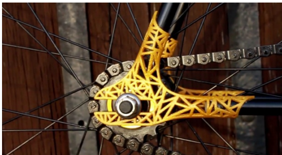
Imagen 4.1.2-1 unión del cuatro de bicicleta impreso en SLS. ( http://www.vorwaertz.com )
