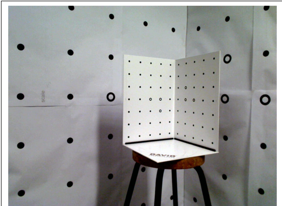
Imagen 3.2.2-2 fondos de calibración estándar y de gran tamaño
