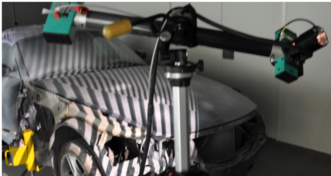
Imagen 3.2.1-3 Escáner de luz estructurada. El elemento de la derecha es un proyector, y el de la izquierda una cámara
