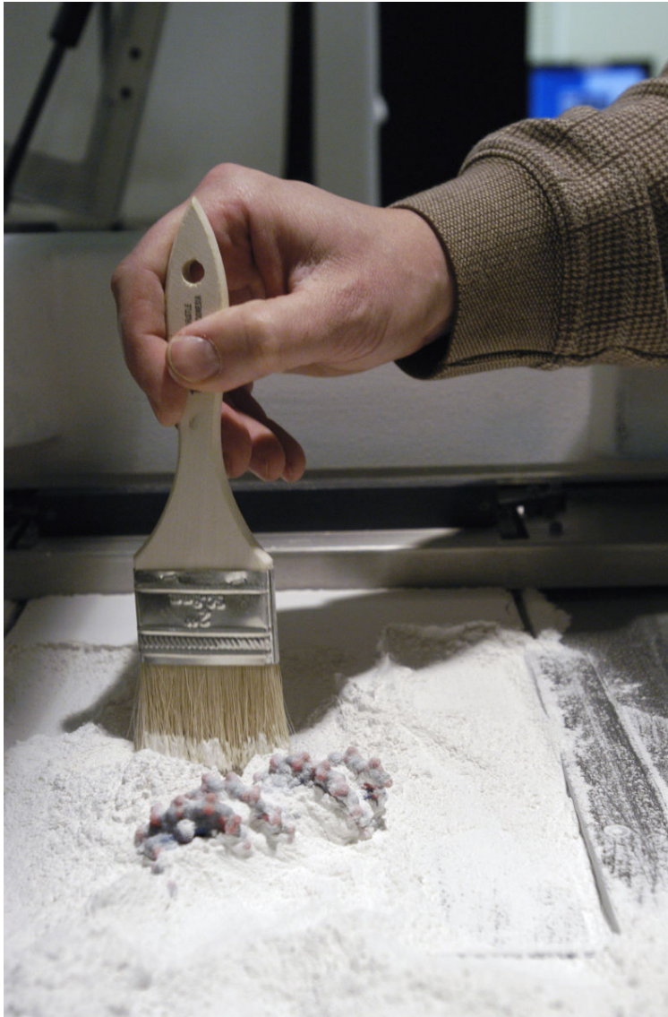
Imagen 4.2.1-2 Proceso de limpieza en una impresora Zcorp
