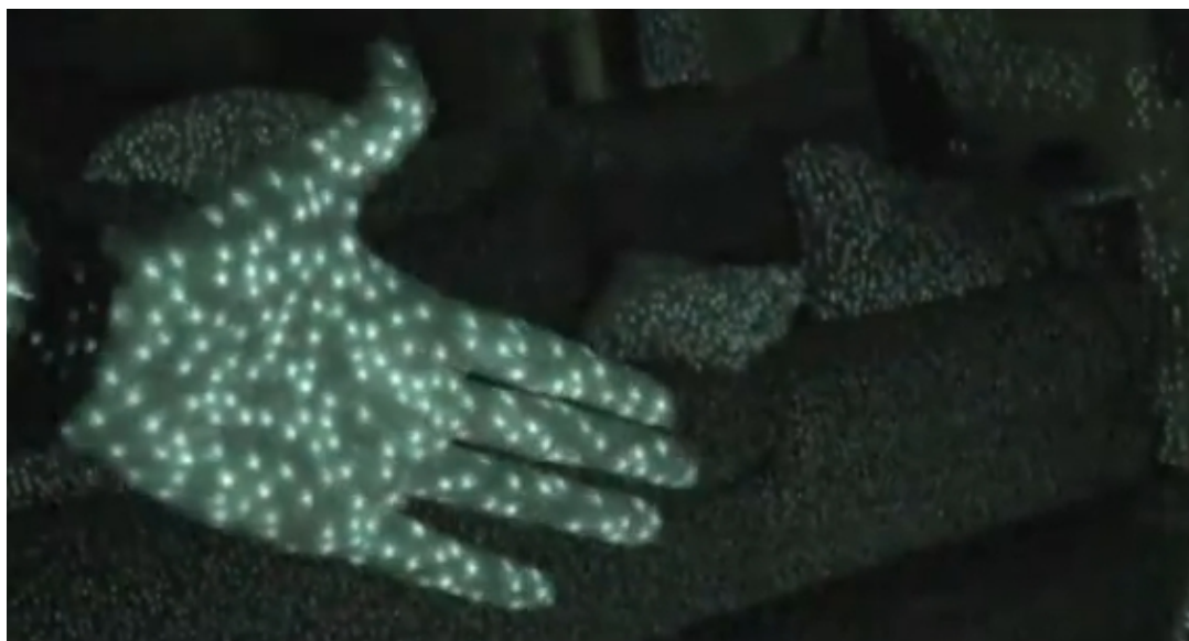
Imagen 3.2.3-9 Nube de puntos del proyector infrarrojo de Kinect
