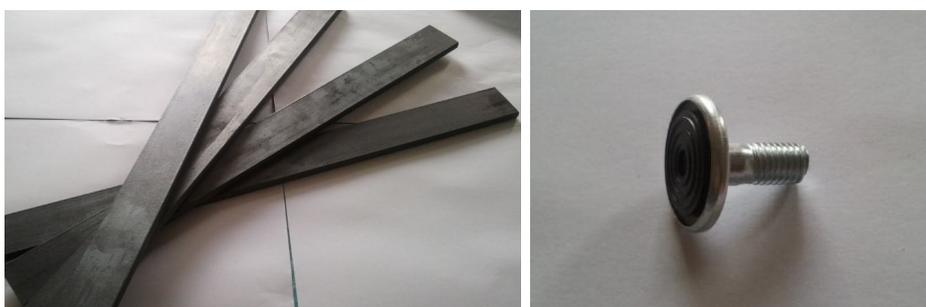
Figura 9.13.: Patas y apoyos (x8) comprados para afianzar la base del brazo robot
