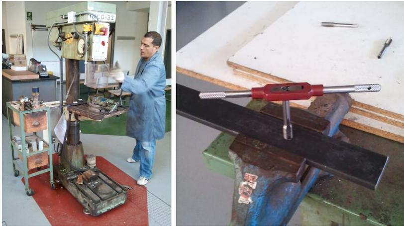
Figura 9.14.: Herramientas y mano de obra empleada en el taller convencional: (Izquierda) Taladro de columna con Pedro a los controles; (Derecha) Macho de roscar desbastando patas
