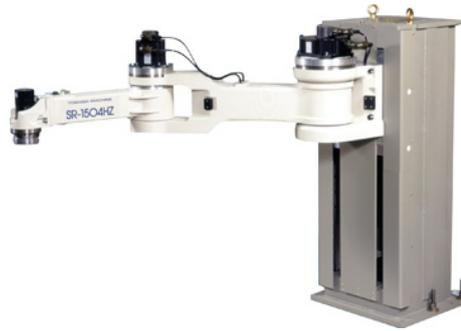
Figura 2.2.: Robot SCARA compacto (ARCTECH). Disposición en Direct-Drive
