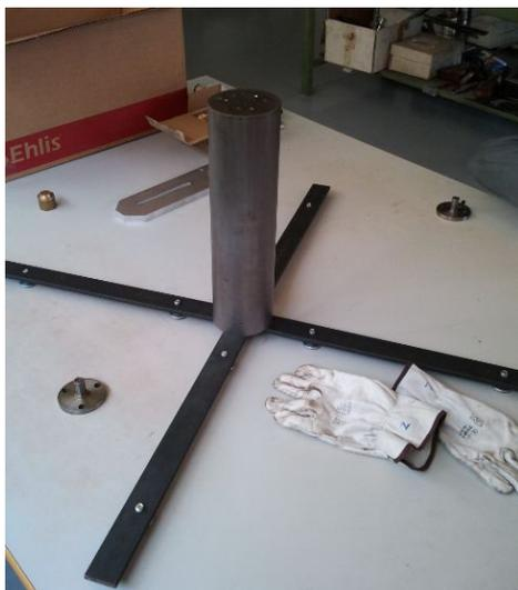
Figura 9.16.: Patas ensambladas al cuerpo, con los apoyos de rosca ya colocados
