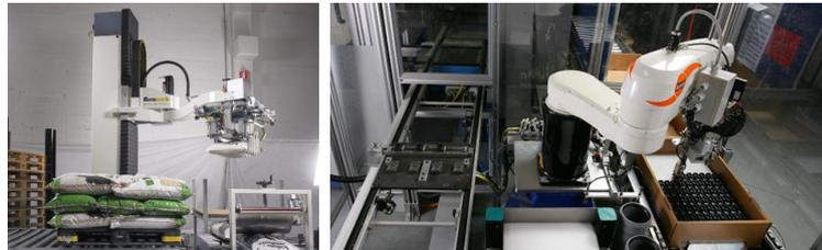
Figura 2.1.: Ejemplos de robots SCARA siendo utilizados en la industria moderna. (Izquierda) Tarea de paletizado; (Derecha) Tarea de reposicionado
