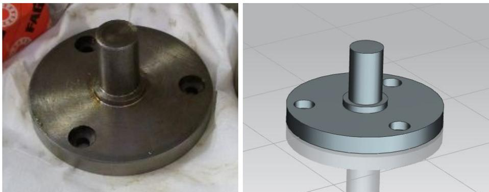
Figura 9.12.: Fotografía de la pieza acoplamiento acabada y su modelo CAD
