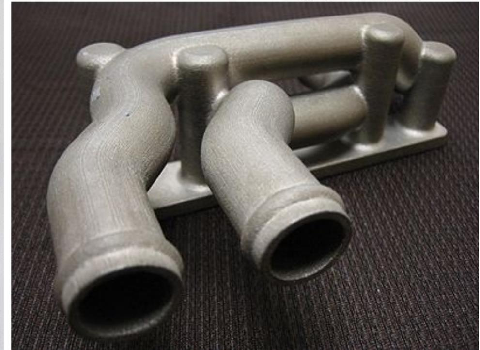
SL con resinas LaserForm metálica
