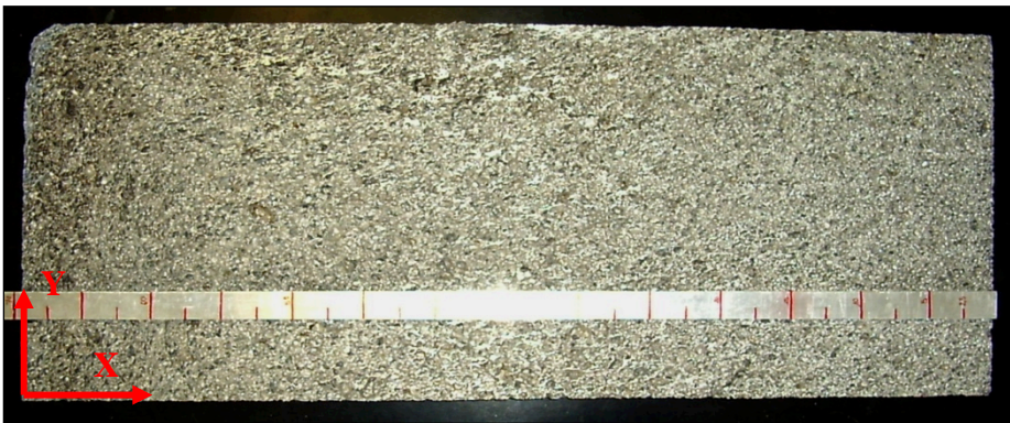
Figura 3.11. Situación de origen de coordenadas para la obtención de las probetas.
