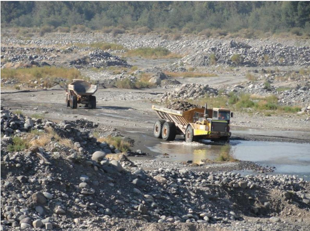
*Fig. 14. Trabajos de extracción de áridos en el cauce del río Palancia.*
