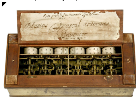
Pascalina (1642) abierta, donde pueden verse las ruedas dentadas numeradas y conectadas entre sí.
