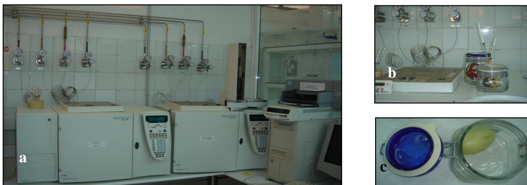
Fotografía 3.15.- Equipo GC formado por cromatógrafo de gases, columna y detectores, unidos a equipo con software procesador de datos (a y b); recipiente en el que se introducían los frutos para ser analizadas la tasa respiratoria y la producción de etileno (c).
