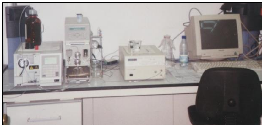
Fotografía 3.14.- Equipo HPLC formado por bomba isocrática, columna y detector, unidos a equipo con software procesador de datos.
