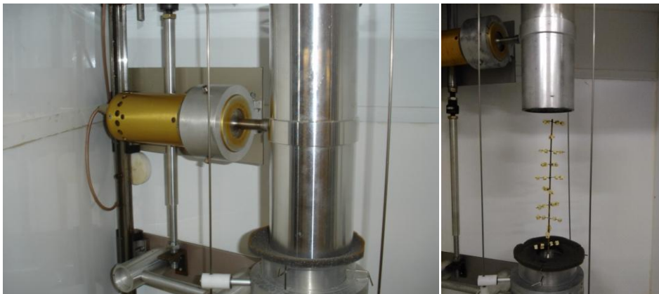
Figura 1.5. Cámara de secado cilíndrica utilizada para la aplicación de ultrasonidos sin contacto directo entre el emisor y el alimento.
