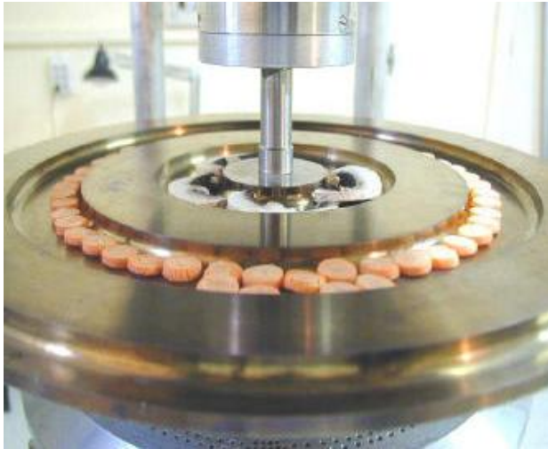
Figura 1.4. Placa escalonada circular utilizada para la aplicación de ultrasonidos por contacto directo entre el emisor y el alimento.
