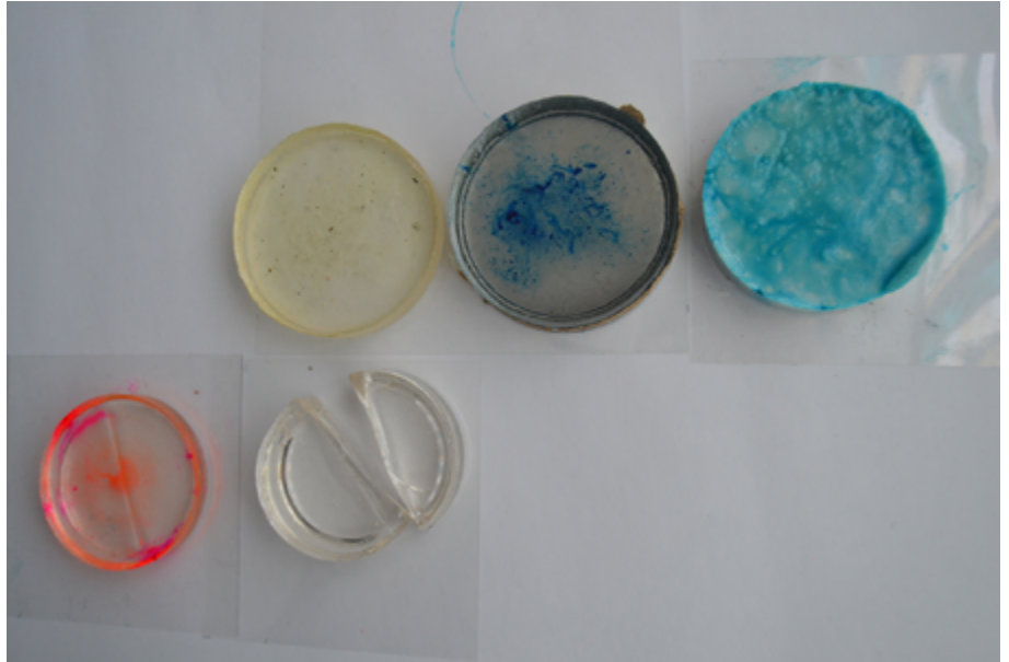
Fig. 7. Investigación con distintos tipos de resinas poliéster y su reacción con diversos tintes.
