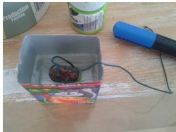
Fig. 5. Prueba encapsulado en tetrabrick y sujeción de alambre.
