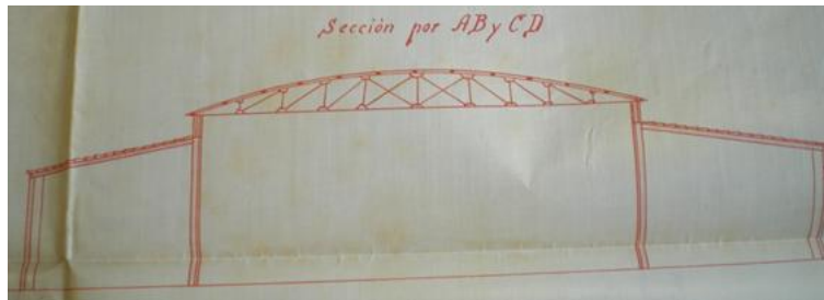
Figura 25. Sección Tipo de ampliación del Garaje Victoria.
