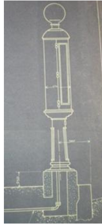
Figura 23. Detalle de surtidor de gasolina instalado en un garaje, año 1927.
