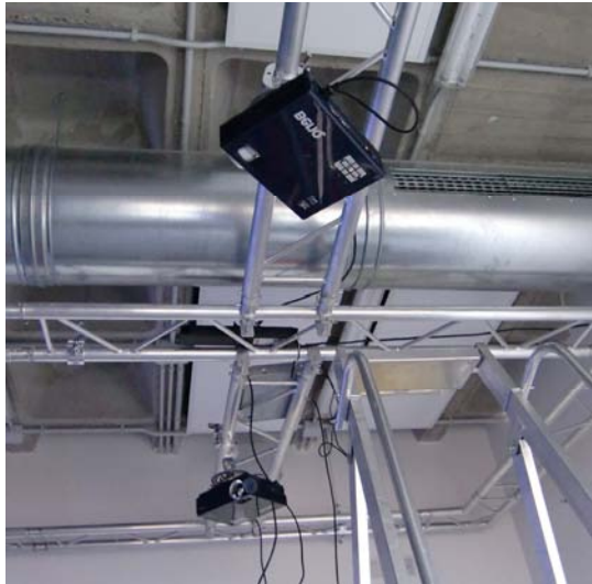
Entre Pliegues. Montaje proyectores de vídeo en ángulo de 100°. (Img. xcviii )
