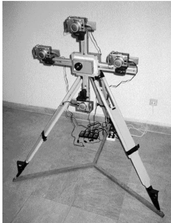
Figura 3.23.- Sistema de medición MEDPHOS (Malian et al., 2004)
