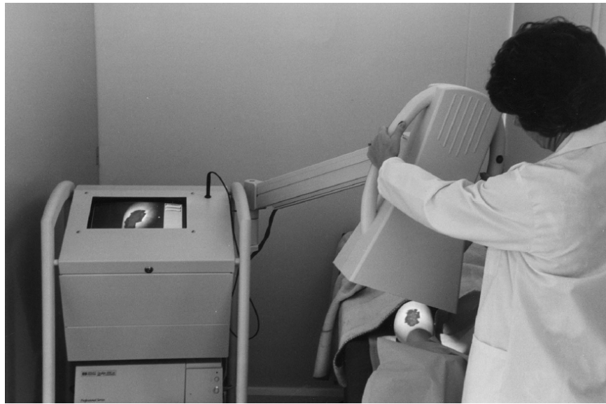
Figura 3. 19.- Instrumento de medición con luz estructurada MAVIS. (Plassmann et al., 1995)
