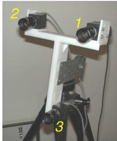
Figura 3. 2.- Sistema de adquisición de imágenes (D'Apuzzo & Verius, 2008)
