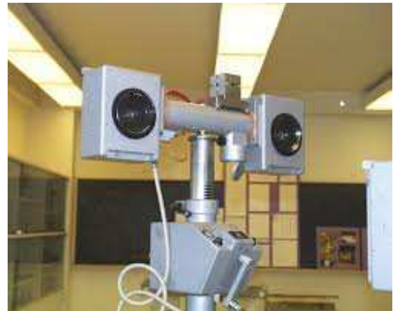
Figura 2. 25.- Cámara estereoscópica ZEISS SMK 40 ( www.zeiss.com )
