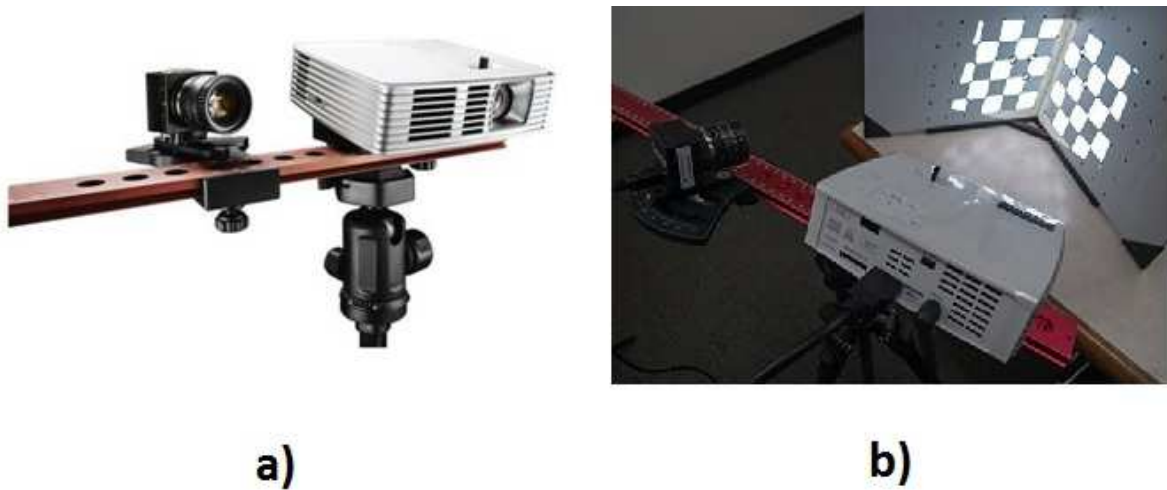
Figura 3. 31.- a) Dispositivo DAVID escáner montado sobre trípode; b) DAVID escáner en un momento del proceso de calibración < http://www.david-3d.com >
