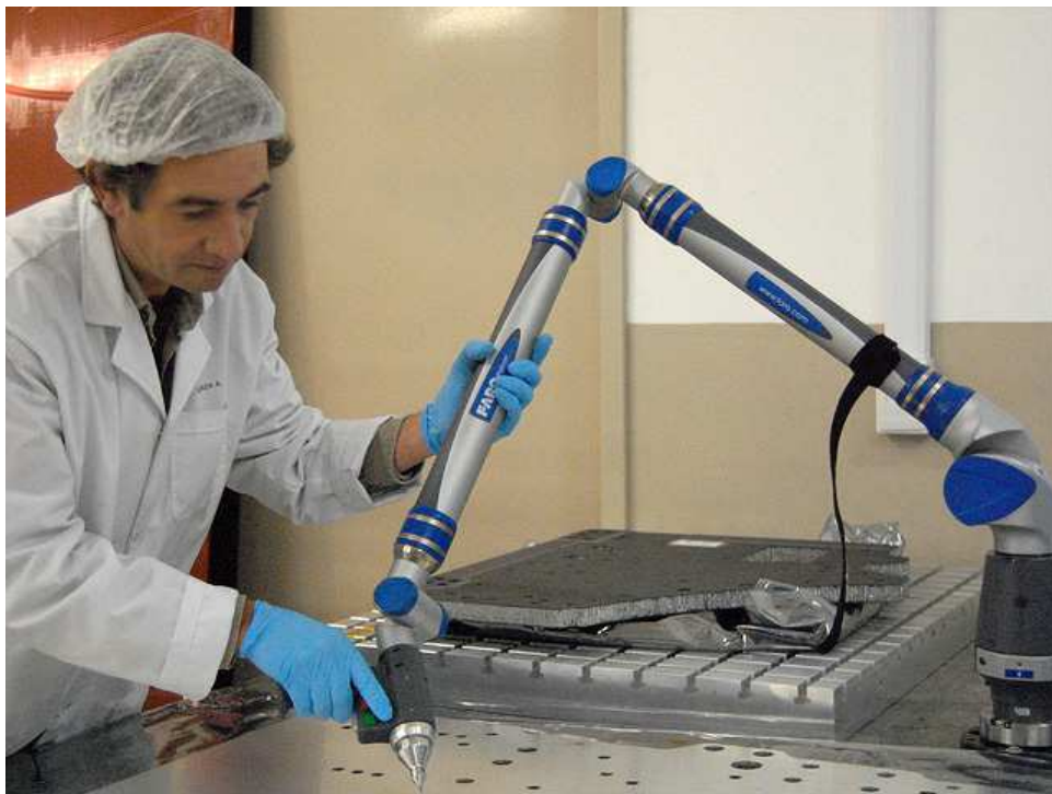
Figura 2. 13.- Brazo de medición FARO < www.mecanica14.com >
