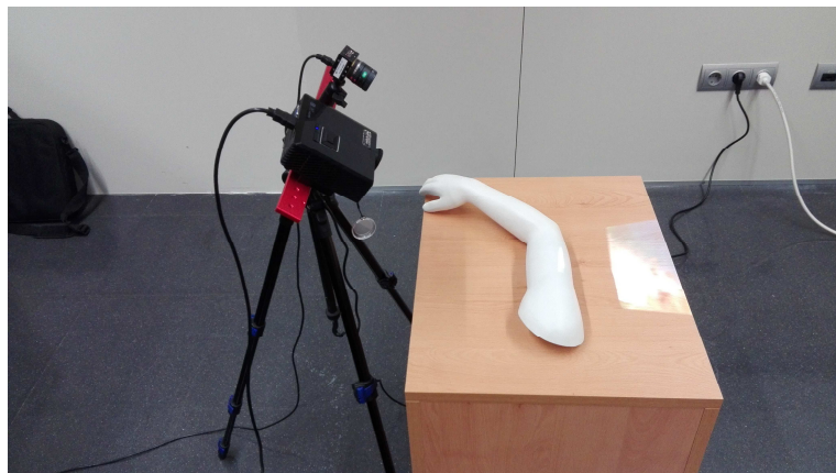
Figura 4. 25.- Sistema de medición por luz estructurada David Scanner.
