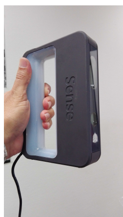
Figura 4. 26.- Sistema de medición por triangulación láser SENSE 3D
