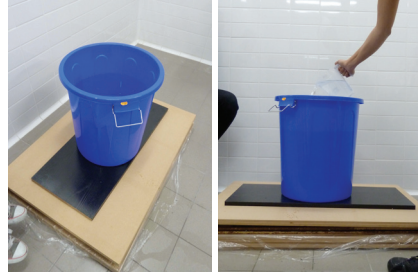
Fig 238 y 239. Prensado del papel por acción del agua. El peso debe aumentar de forma gradual. Imágenes de archivo de la autora.
