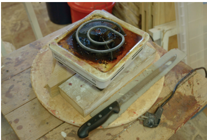
Figura 70. Hornillo eléctrico y cuchillo de corte. Si necesitamos cortar material, podemos calentar un cuchillo para que resulte más fácil. Figura 71. Cazo para calentar los pequeños trozos de cera. Imágenes del archivo de la autora.
