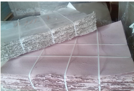
Figura 101. Hojas de cartón piedra o cartón fallero tal. Se utiliza para fabricar muñecos artesanales como los ninots de las fiestas falleras, teniendo también una gran salida en el mundo de las máscaras. Imagen obtenida de http://www.contracoladosgar.ce.es/es/producto/CARTON-PIEDRA-CARTON-FALLERO/ 8-9-2015
