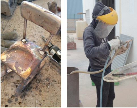
Figura 57. Una mecedora ya montada a falta de terminar el repasado de las soldaduras. Figura 58. Chorreo de la pieza. Una vez que la arena ha sido tamizada se puede utilizar para sacar el color del bronce sin riesgo de que pueda estropear la superficie. Imágenes del archivo de la autora.
