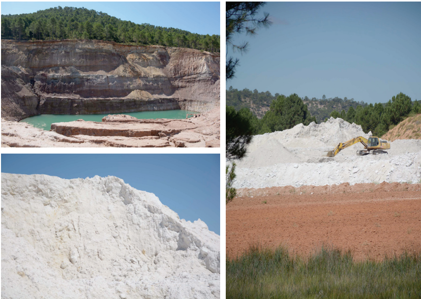
Figura 6. Mina de caolín agotada a cielo abierto. Cuenca 2015. Figura 7. Detalle del mineral de caolín antes de ser trasladado a fábrica para su procesado. Figura 8. Proceso de almacenaje del mineral en acopio. Imágenes de archivo de la autora.
