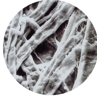
Figura 104. Microscopía de las fibras de papel de una hoja prensada. El número de fibras y la longitud de las mismas influyen decisivamente en la resistencia del papel. Imagen obtenida de ASUNCIÓN, Josep. El Papel. Técnicas y métodos tradicionales de elaboración. Ediciones Parramón. Barcelona, 2009:20.
