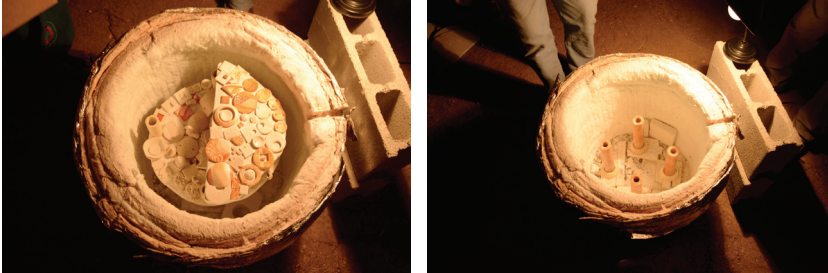
Figura 144. Horno frío. Una vez que el horno está frío se pueden retirar las piezas. Figura 145. Aspecto del horno tras la retirada de las piezas y estantes. Aquí podemos apreciar las bases sobre la que se montaron las plataformas. Como se puede apreciar en la imagen, éstas no se colocan directamente sobre el suelo del horno. Hay que tener en cuenta los tiempos de cocción, para aprovechar mejor las horas del día. Al realizar la cocción a medio día, la descarga tuvo que hacerse por la noche. Imágenes de archivo de la autora.
