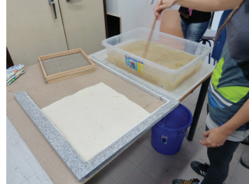
Figura 229. Preparación de la batea. Los movimientos circulares ayudan a mezclar la fibra, el agua y el ayudante de formación. Véase como se ha procedido a organizar el espacio de trabajo. Imagen de archivo de la autora.
