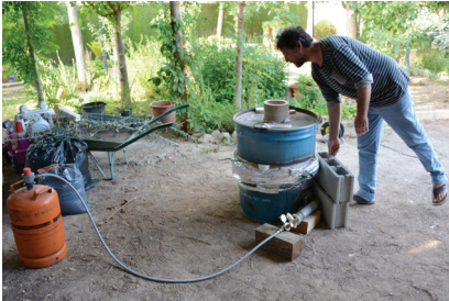
Figura 139. Comprobación de la llama. A 700°C todavía se pueden distinguir las piezas del interior del horno, a 980°C esto ya no es posible. Figura 140. Detalle de la chimenea. Imágenes de archivo de la autora.
