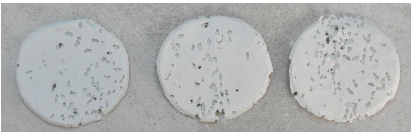
Figura 122. Textura conseguida gracias a unos granos de arroz que se incorporaron en la masa y que desaparecieron tras la cocción. Trabajos de clase. Imágenes de archivo de la autora.
