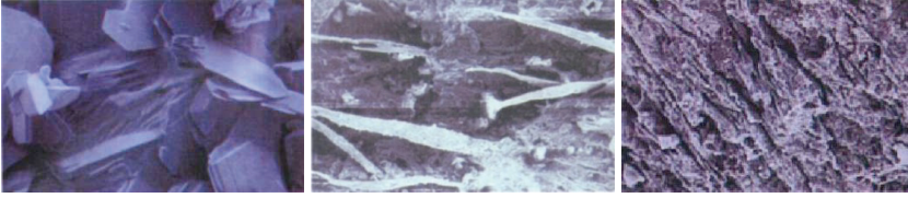
Figura 88. Micrografía electrónica de partículas de caolín. Cortesía de Walter Keller, de la Universidad de Missouri. Figura 89. Micrografía electrónica del cuerpo de una arcilla de papel de Rosette Gault antes de ser cocida. Cortesía de David Kingery, Universidad de Arizona. Figura 90. Micrografía electrónica de la muestra de arcilla de papel después de la cocción. Cortesía de David Kingery, Universidad de Arizona. Imagen obtenida de GAULT, Rosette. The Potential of Paperclay [en línea]. Graham Hay [ref. de 8-9-2015]. Disponible en web: http://www.grahamhay.com.au/gault1994cap.html
