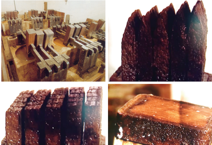
Figura 138. Pilas trituradoras Molino Capellán Barcelona. Imagen obtenida de: ASUNCIÓN, Josep. El Papel. Técnicas y métodos tradicionales de elaboración. Ediciones Parramón. Barcelona, 2009:48. Figura 139, 140 y 141. Terminaciones de las diferentes mazas. Imágenes obtenidas de: https://www.youtube.com/watch?v=EvBcM1ZMyrE (Fecha de actualización 05-10-2015)
