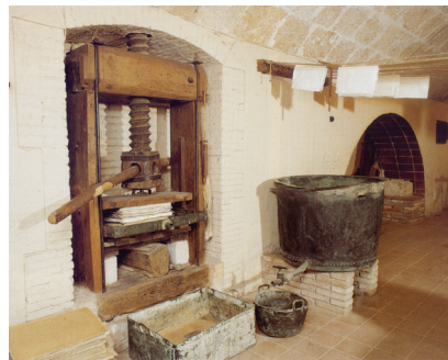
Figura 144. Caldera y prensa de encolar. Imagen obtenida de: ASUNCIÓN, Josep. El Papel. Técnicas y métodos tradicionales de elaboración. Ediciones Parramón. Barcelona, 2009: 50.
