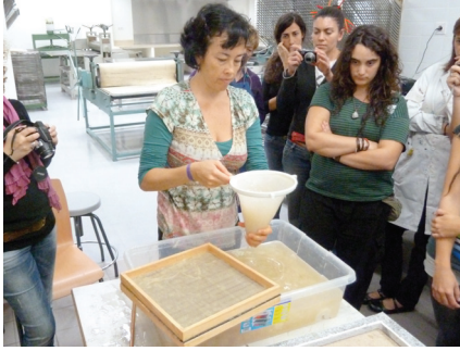
Figura 231. Retirada de fibra de la batea. Mediante un filtro de tela extraemos la cantidad de fibra necesaria para equiparar las concentraciones de fibra y agua. Imagen de archivo de la autora.
