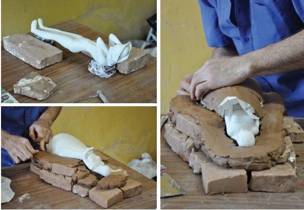
Figura 330, 331 y 332. Elaboración de una cama para la primera parte del molde de escayola. Trabajo de autor. Imágenes de archivo de la autora.
