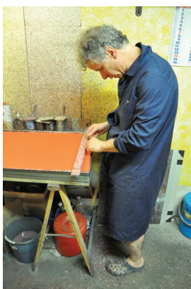
Figura 188 y 189. Colocación de la hoja y ajuste de la guía. Imágenes de archivo de la autora.
