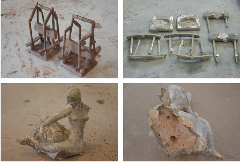
Figura 53. Resultado tras la fundición, montaje listo para ser despiezado. Figura 54. Despiece. Esas piezas corresponden al despiece de dos sillas. Las diferentes partes tendrán que ser soldadas. Figura 55. Vista de la pieza antes de ser limpiada. Figura 56. Parte inferior de la pieza fundida. Trabajo de autor. Imágenes de archivo de la autora.
