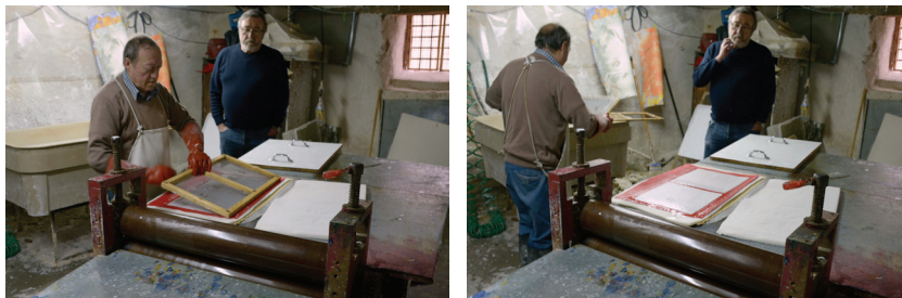
Figura 204 y 205. Retirada de la forma. Durante este momento es importante comprobar que la hoja haya quedado bien fijada en el fieltro. Como se puede apreciar en esta última imagen por el brillo de las hojas éstas tienen todavía una gran cantidad de agua. Imágenes de archivo de la autora.
