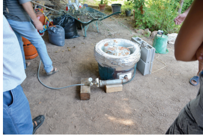
Figura 137. Horno una vez cargado. Figura 138. Encendido del horno abierto. En esta imagen se puede ver la caña pirotécnica del termómetro. Las hay para alta y baja temperatura. Imágenes de archivo de la autora.
