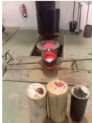
Figura 51. Crisol acoplado al manoral listo para ser elevado con la grúa.
