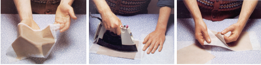
Figura 125. Las fibras de papel ya se han unido formando la hoja, sin embargo ésta aún tiene exceso de humedad, lo que la hace especialmente flexible. Figura 126. Al planchar una hoja de papel en estado húmedo no sólo se acelera el secado, también se consigue un acabado liso. Si se plancha el papel cuando está seco se consigue un efecto satinado sobre la hoja. Figura 127. Una vez que la hoja está seca se puede separar fácilmente de su soporte. Imágenes obtenidas de: WATSON, David. Cómo hacer papel artesanal. Papel hecho a mano con materiales reciclados y componentes naturales. Primera edición en castellano. Madrid. Ediciones Celeste S.A.1996: 25, 26 y 27.
