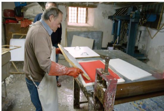
Figura 203. Puesta de la hoja. La forma se centra en el fieltro apoyándose en uno de sus lados. Imagen de archivo de la autora.
