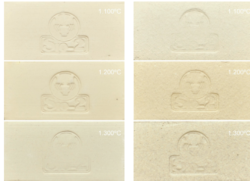
Figura 123. PRAI. Figura 124. PRAF. Imágenes después de la cocción. Ambas tienen una temperatura de cocción que oscila entre los 1.240-1.300°C. El bizcochado ronda los 1.000°C. Con poca contracción durante el secado 5.9% y 5.4% respectivamente. Presentan una mayor contracción durante la cocción cuando esta llega a 1.300°C, siendo mayor en la fina 7.0% y 4.6% respectivamente. Información e imágenes obtenidas de http://www.sio-2.com/es/prai---refractaria-blanca/subfamilia/14 (2-6-2015).
