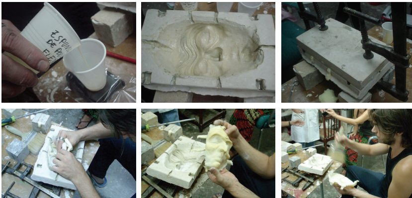
Figura 28, 29, 30, 31, 32 y 33. Secuencia de trabajo. Mezcla de componentes para la espuma de poliuretano. Vertido en el molde. Fijación de las partes del molde mediante gatos. Extracción de la máscara tras apertura del molde. Comprobación del resultado. Aplicación a brocha de una capa de talco. Imágenes del archivo de la autora.
