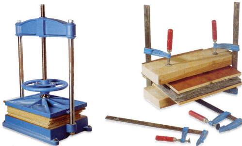
Figura 123 y 124. Tipos de prensa utilizadas para las hojas de papel. La primera es una prensa de hierro de fabricación actual, la segunda es una prensa casera. Los tablones superiores ayudan a repartir la presión realizada por los gatos. Imagen obtenida de: ASUNCIÓN, Josep. El Papel. Técnicas y métodos tradicionales de elaboración. Ediciones Parramón. Barcelona, 2009: 55.
