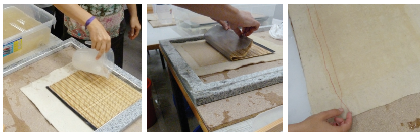
Figura 235. Humedeciendo el su para facilitar su retirada de la primera hoja formada. Figura 236. Retirando el su de la hoja de papel. Figura 237. Colocación de los hilos entre las diferentes hojas. Hay que recortar los hilos por fuera de las hojas para que no sean muy largos y no puedan enredarse con nada durante el manipulado de la posta. Imágenes de archivo de la autora.
