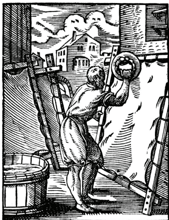
Figura 131. Grabado que representa el proceso de raspado del pergamino con el lunellum. Controlar la tensión en los tirantes y su ubicación, era muy importante para no rajar la piel. Imagen obtenida de: https://upload.wikimedia.org/wikipedia/commons/f/f1/Permennter-1568.png
