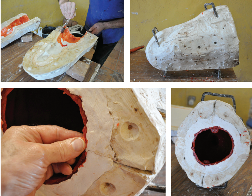
Figura 65. Aplica a pincel de la primera capa del positivo en cera. Los clavos a lo largo del plano de junta evitan que la goma levante del molde. Figura 66. Ganchos para sujetar las partes del molde, evitando que éstas se muevan durante el proceso de vertido de la cera. Figura 67. Aplicación del cordón del material en la base. Con esto se unifica el grosor y se le da más estabilidad a la base. También nos ayuda a reforzar zonas que hayan podido quedarse más débiles. Figura 68. Enganches internos para la peana. Imágenes del archivo de la autora.
