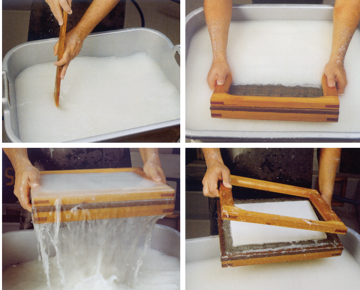
Figura 116, 117, 118 y 119. Formación de una hoja de papel. Este proceso es independientemente del modo de obtención de la fibra. Imágenes obtenidas de: ASUNCIÓN, Josep. El Papel. Técnicas y métodos tradicionales de elaboración. Ediciones Parramón. Barcelona, 2009: 79 y 80.
