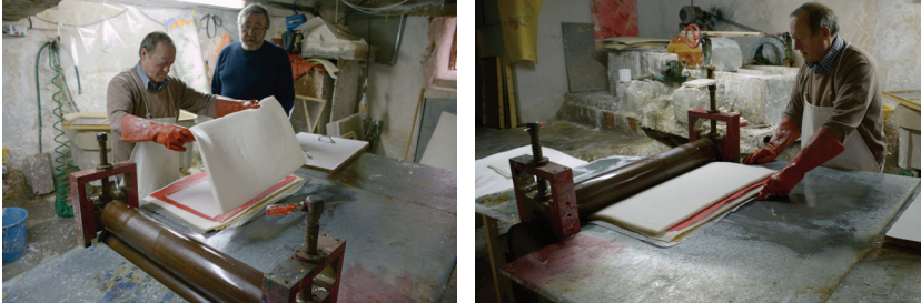
Figura 207 y 208. Proceso de prensado de las hojas. Con este proceso se consigue eliminar gran parte del agua de formación de la hoja siendo posible la manipulación de las hojas. Imágenes de archivo de la autora.
