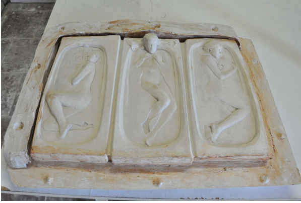
Figura 367. Molde de tres partes para relieve de escayola. Trabajo de autor. Imagen de archivo de la autora.
