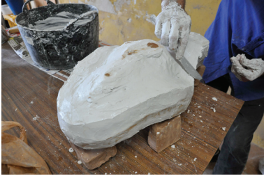
Figura 340. Segunda parte del molde de escayola terminada. Trabajo de autor. Imágenes de archivo de la autora.
