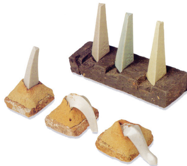
Figura 12. Conos pirométricos. Los conos pirométricos tienen forma tronco-piramidal y están preparados para una velocidad de calentamiento de 150°C por hora (Chavarria, 2002: 63).
