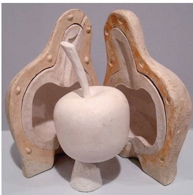
Figura 52. Pieza y molde de yeso para la técnica tradicional de la Cera Perdida. El proceso de cera perdida es un método para pasar una escultura hecha de arcilla o escayola a un material más duro tal como el bronce. Para pasar del modelo original al bronce, se requieren dos moldes. El primer molde sacado de la pieza a reproducir, estaría hecho de yeso y caucho, como puede verse en la imagen. En él se verterá posteriormente cera caliente para que adquiera los detalles que el caucho capturó del modelo. (Imagen: < www.mx.groups.yahoo.com/.../message/15 > Texto: < www.andreharvey.com/spanish/wax.html > [Consulta: 30 Octubre 2008]).
