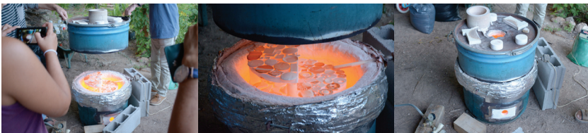
Figura 141. Aspecto del interior del horno una vez que ya se ha llegado a la temperatura de bizcochado. Figura 142. Interior del horno (detalle). Figura 143. Proceso de enfriamiento del horno. Para facilitar este proceso se abren todas las partes del horno. Imágenes de archivo de la autora.
