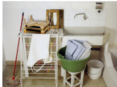
Figura 109. Elementos necesarios para montar un taller con pocos medios. La batidora serviría para refinar el papel. La prensa se ha fabricado con dos tablones y cuatro tornillos de carpintería y el secadero estaría constituido por un tendedero de colada y unas pinzas. Imágenes obtenidas de: ASUNCIÓN, Josep. El Papel. Técnicas y métodos tradicionales de elaboración. Ediciones Parramón. Barcelona, 2009:71
