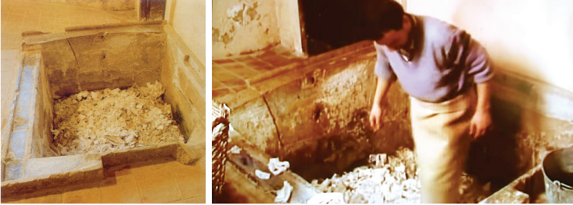
Figura 135. Pudridero. Imagen obtenida de: ASUNCIÓN, Josep. El Papel. Técnicas y métodos tradicionales de elaboración . Ediciones Parramón. Barcelona, 2009: 48. Figura 136. Proceso de pisado del trapo. Imagen obtenida de: https://www.youtube.com/watch?v=EvBcM1ZMyrE
