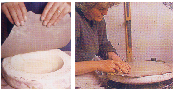
Figura 28. Hacer un cuenco con un molde (Quinn, 2008: 85). Figura 29. Hacer un plato con terraja (Quinn, 2008: 88).
