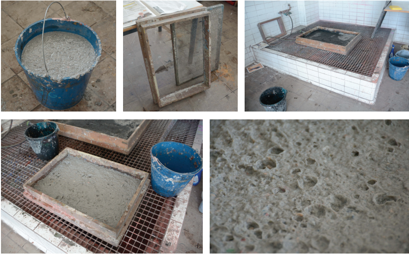
Figura 250. Pasta preparada para el vertido. Figura 251. Molde elegido para la prueba (50 x70 cm). Figura 252. Zona de vertido. En la imagen podemos ver un trabajo de clase. Figura 253. Hoja formada. Figura 254. Detalle de la textura de una de las caras. Imágenes de archivo de la autora.
