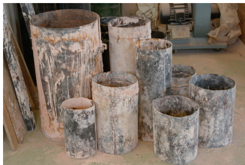
Figura 50. Dependiendo de las dimensiones del molde cerámico se elegirá un cilindro u otro. Imagen del archivo de la autora.
