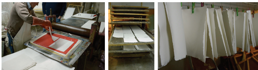
Figura 209. Retirada de las hojas del fieltro. Figura 210. Secaderos a modo de estantes. Figura 211. Cuerdas de secado. Las hojas de papel ya separadas se colocan bien en bandejas que se introducen es estanterías adaptadas o se tienden. Imágenes de archivo de la autora.
