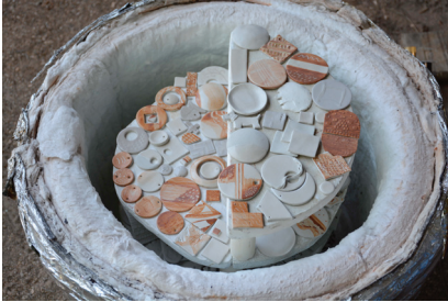
Figura 137. Horno una vez cargado. Figura 138. Encendido del horno abierto. En esta imagen se puede ver la caña pirotécnica del termómetro. Las hay para alta y baja temperatura. Imágenes de archivo de la autora.
