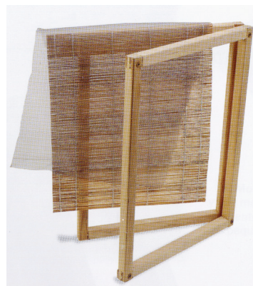
Figura 132. Molde para la fabricación de papel japonés. La malla siempre es verjurada y va independiente del marco. Imagen obtenida de: Asunción, Josep. El Papel. Técnicas y métodos tradicionales de elaboración. Ediciones Parramón. Barcelona, 2009. Pag 63.
