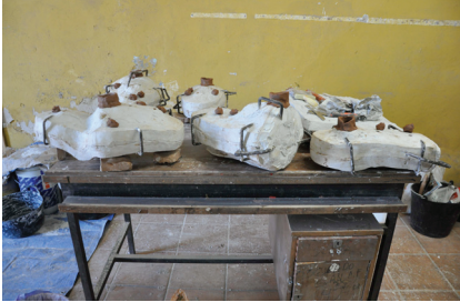
Figura 346. Moldes preparados para la primera colada. Normalmente se preparan varios moldes para colar a la vez. Imagen de archivo de la autora.
