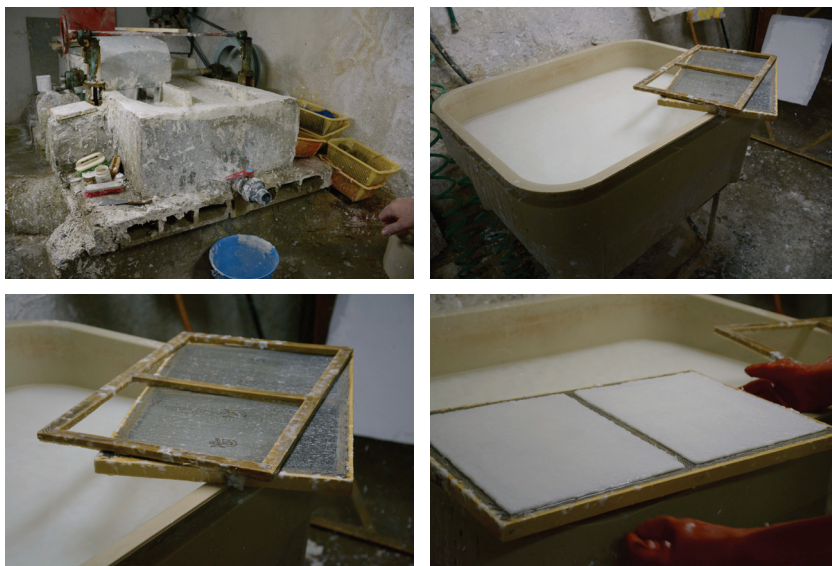
Figura 199. Pila holandesa de obra. Figura 200. Tina de mezclas cargada lista para ser utilizada. Figura 201. Forma y marco. En la imagen vemos el detalle de la filigrana de hilo de cobre cosido a la malla de metal galvanizado de la forma. Figura 202. Aspecto de las dos hojas de papel tras quitar el marco de la forma. Una vez que quitamos el marco podemos ver el grosor de la capa de fibra de celulosa que hemos obtenido tras sumergir forma y marco en la tina y recoger material. Es importante esperar con la forma y el marco unos segundos sobre la tina para que escurra la mayor cantidad de agua posible. Imágenes de archivo de la autora.
