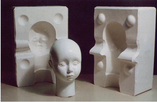
Figura 34. Modelado para la cabeza de una muñeca de porcelana china de Lennox, con su molde de dos piezas para moldearla en colada (Peterson, 2003: 60).
