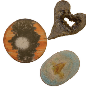
Figura 158. Defectos de la cocción en microondas. Trabajos de otros cursos. Imagen de archivo de la autora.
