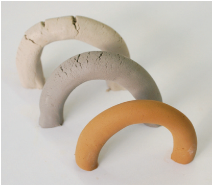
Figura 4. Comprobación de plasticidad. Consiste en formar una aduja (rollo) a partir de una pella previamente amasada y doblarla en arco. Si, al doblarla, la arcilla o pasta se agrieta, es señal de que es poco plástica. Dependiendo del tamaño y concurrencia de las grietas, será mayor o menor la cantidad de material plástico que se habrá de agregar para corregirla. Imagen obtenida de: http://www.ceramicatrespiedras.com/cursos/apuntes/plasticidad-encogimiento-y-densidad-de-las-arcillas/ 25-9-2015
