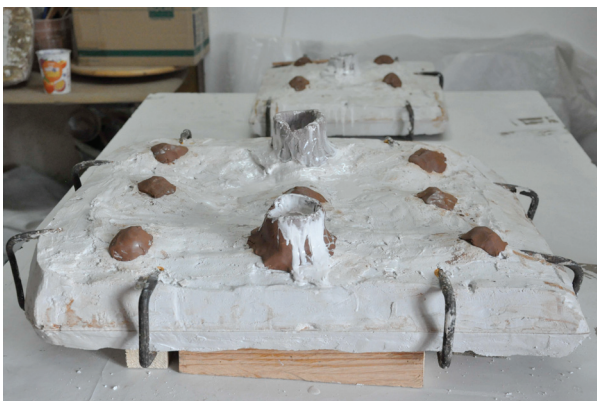
Figura 370. Aspecto de los moldes tras la colada de la silicona. Imagen de archivo de la autora.
