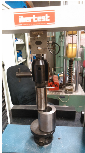
Figura 2.16. Máquina de ensayos universal electromecánica Elib 50
