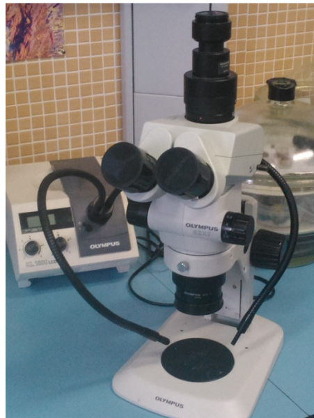
Figura 2. 5. Lupa estereoscópica modelo Olympus SZX7
