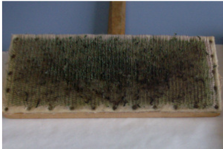
Figura 2. 4. Cardas manuales provistas de guarnición
