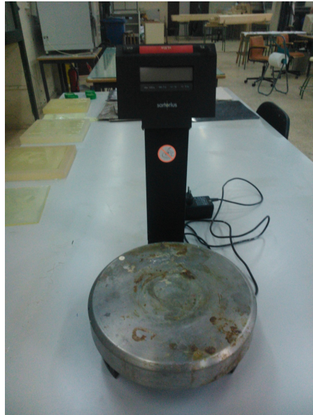
Figura 2. 8. Balanza de precisión marca Sartorius
