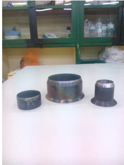
Figura 2.13. Troqueles de 42 mm, 60 mm, 100 mm, de diámetro, con el canto biselado
