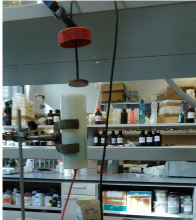
Figura 2.19. Detalle del vaso con los electrodos y la pinza retén
