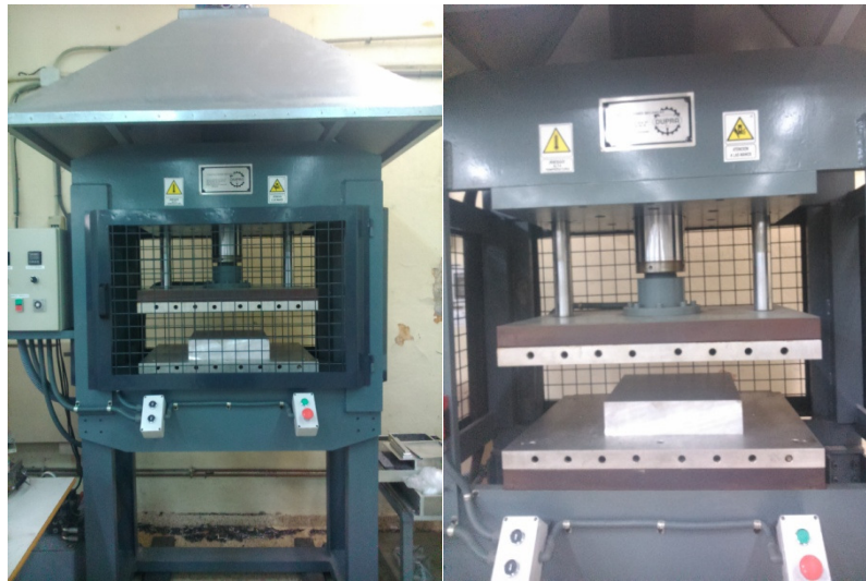
Figura 2.12. Prensa hidráulica de 50 Tn equipada con platos calientes
