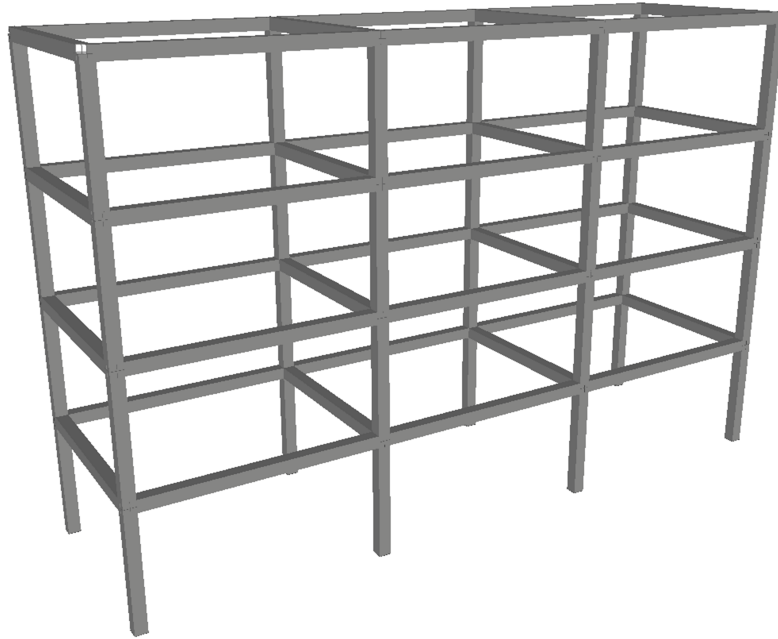
Figura 2.8: Modelización de una estructura mediante barras.
