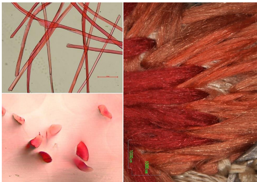
Figura 200. Imágenes con MO de la sección longitudinal y transversal de las fibras de seda roja, e imagen con ME de puntos de bordado al matiz con hilaturas de esta seda, correspondiente a un manipulo del terno del obispo Tormo .
