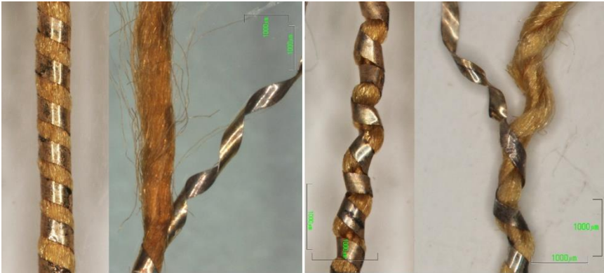
Figura 124. Imágenes con ME de las tipologías de entorchados lisos y briscados o rizados, donde se observa como en estos últimos su alma está compuesta por un hilo doble de seda.
