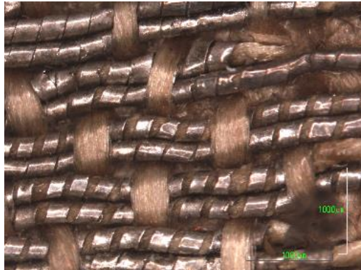
Figura 214. Imagen con ME de bordados con hilos tendidos metálicos paño de hombros del terno del Sol .
