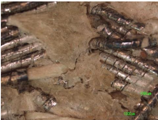
Figura 318. Imagen con ME donde se aprecian los restos de colas orgánicas aplicadas en el reverso de los bordados
