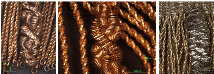
Figura 251. Imágenes con ME de las áreas de flecos aplicación de gusanillos
