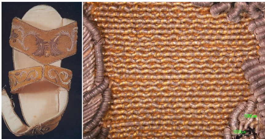
Figura 149. Imágenes con ME del tisú con tramas metálicas de hilo entorchado perteneciente las sandalia antigua sin pareja (S. XIX).
