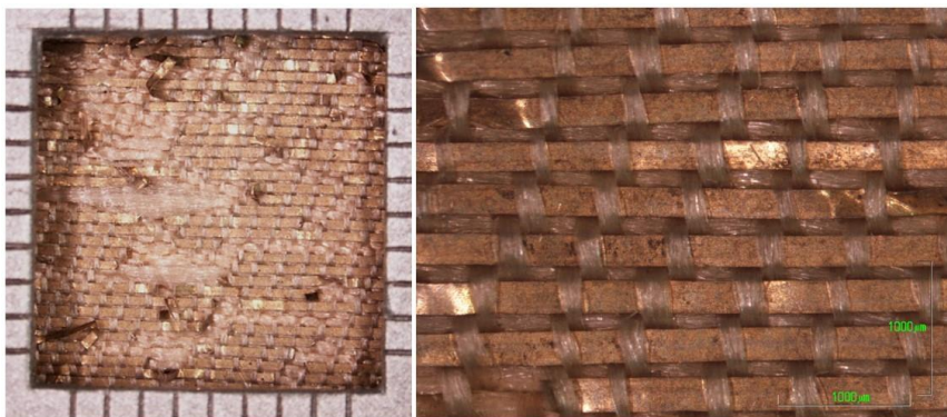
Figura 296. Imágenes con ME del haz del tejido de lamé donde se observan las tramas metálicas.
