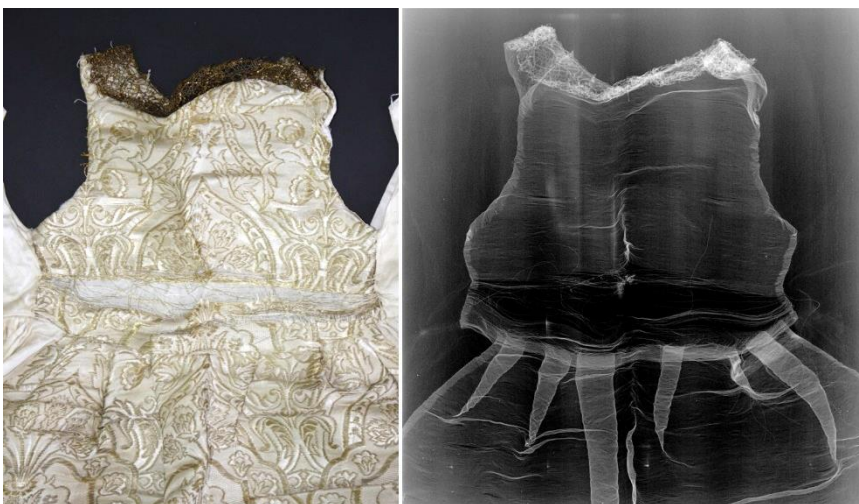
Figura 163. Parte superior del vestido del Alma de la Virgen , donde en su imagen radiográfica se puede apreciar como las tramas metálicas lanzadas y recorren el ancho de la tela, y en la imagen con luz visible sólo son vistas por el anverso cuando lo requiere el dibujo.
