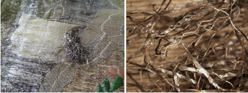
Figura 421. Pérdidas y enmarañamiento de tramas metálicas del tejido labrado espolinado de las caídas del dosel de la cama
