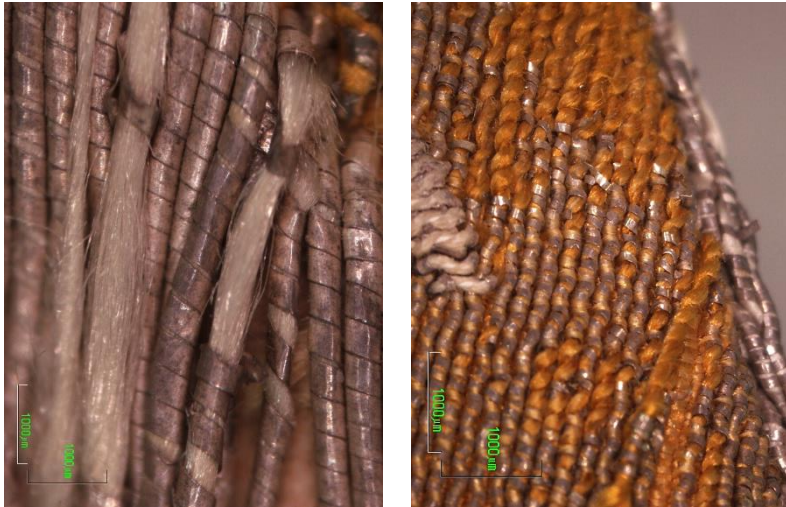
Figura 439. Imágenes con ME de pérdidas de laminillas metálicas dejando el hilo del alma al descubierto.
