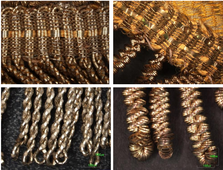
Figura 250. Imágenes con ME de las áreas superior e inferior de flecos con hilos entorchados y de canutillos.
