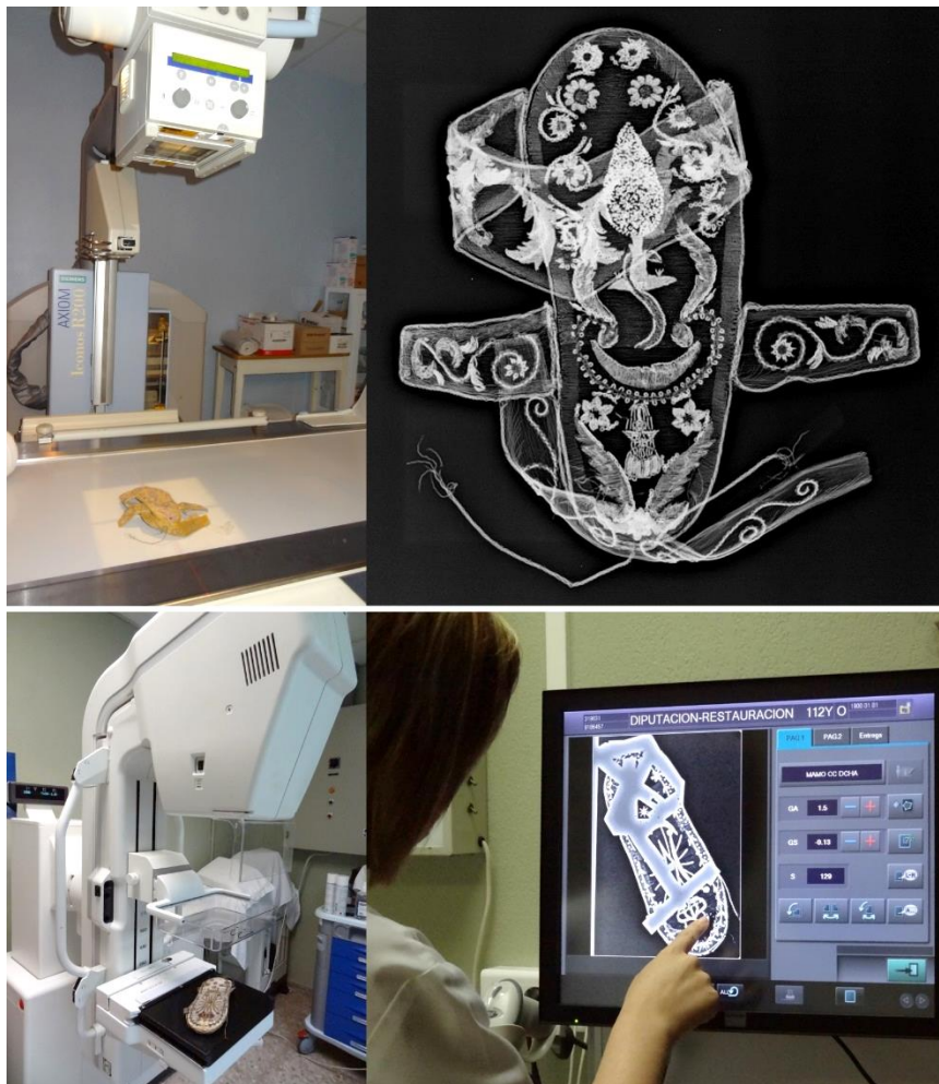
Figura 110. Técnicas globales de examen por imagen: Estudios radiográficos y con técnicas de mamografía con equipos de radiodiagnóstico médico digital.
