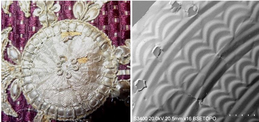
Figura 193. Imágenes con ME y SEM en modo topográfico de planchas metálicas circulares plateadas con superficies incisas, aplicadas en los bordados del conjunto de vestiduras de morado o de Rogativos del siglo XVIII.
