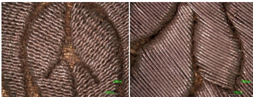
Figura 321. Imágenes con ME donde se aprecian los diferentes efectos producidos por el uso de hilos entorchados rizados y lisos, ambos dispuestos tendidos sobre los moldes de pergamino.
