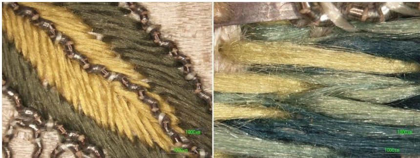
Figura 198. Imágenes con ME de bordados con tonalidades verdes y amarillas realizados con hilaturas de seda lasa.
