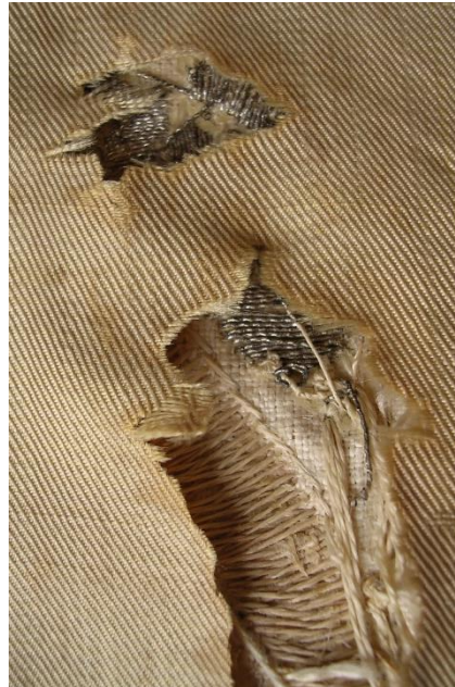
Figura 405. Ejemplo de resistencia del material metálico al ataque de insectos.
