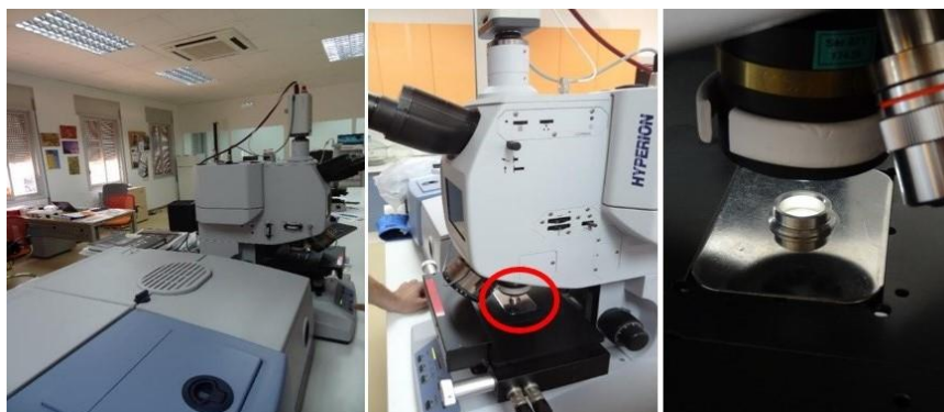
Figura 114. Equipo de espectroscopía infrarroja por transformada de Fourier (FTIR) acoplado a microscopio de transmisión, empleado para la determinación de los tipos de adhesivos.
