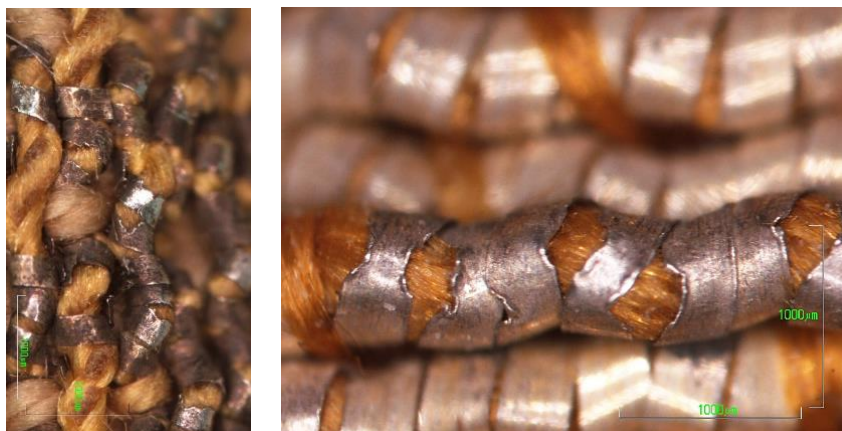
Figura 437. Imágenes con ME del deterioro mecánico de las laminillas metálicas de un hilo entorchado rizado.
