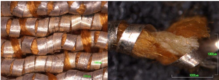
Figura 278. Imágenes con ME de la técnica de aplicación del hilo entorchado rizado dorado ( trama decoración ), se observa como el alma del mismo está realizado con un hilo de dos cabos de diferentes colores.
