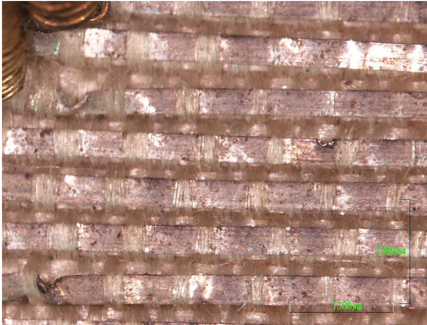
Figura 345. Imagen ME del aspecto del tejido de lamé plateado original.
