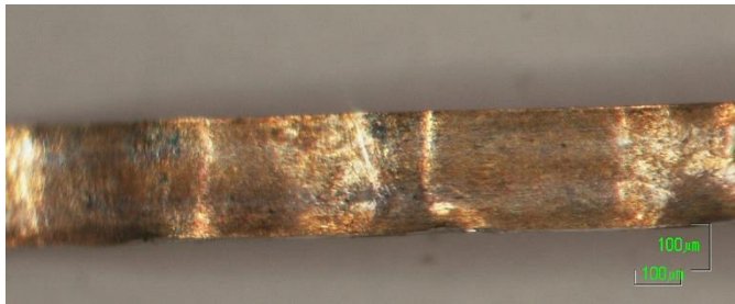
Figura 454. Imagen ME de una laminilla de plata dorada con pérdidas del dorado superficial.
