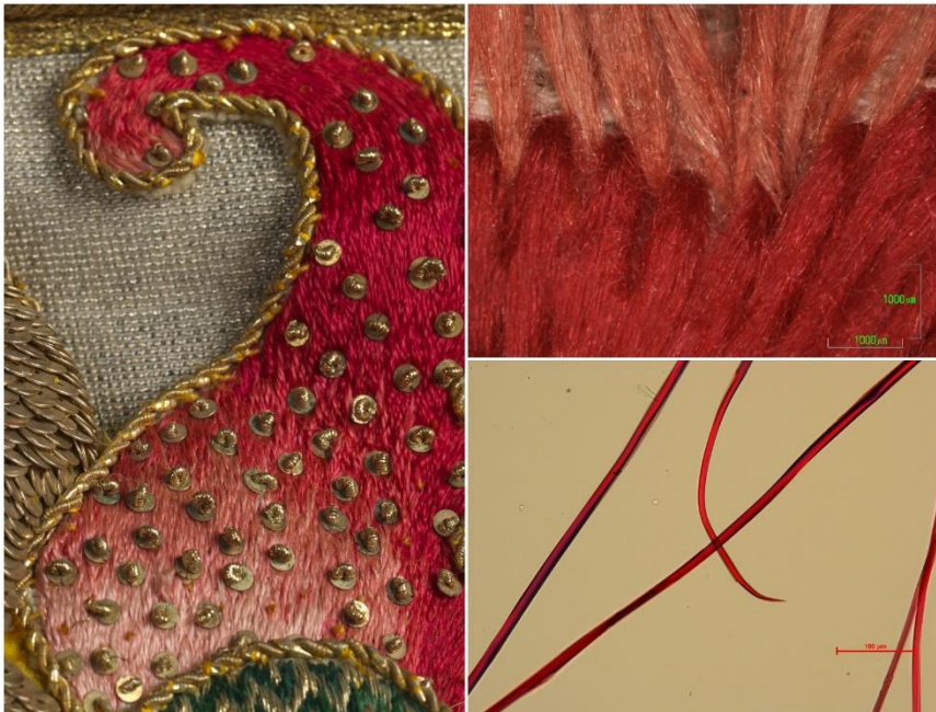
Figura 375. Detalle del bordado con hilaturas de seda de color rojo correspondientes a uno de los grifos alados del vestido. Imágenes con ME de los puntos de matiz y de MO de la sección longitudinal de las fibras de seda (muestra CCo.6).
