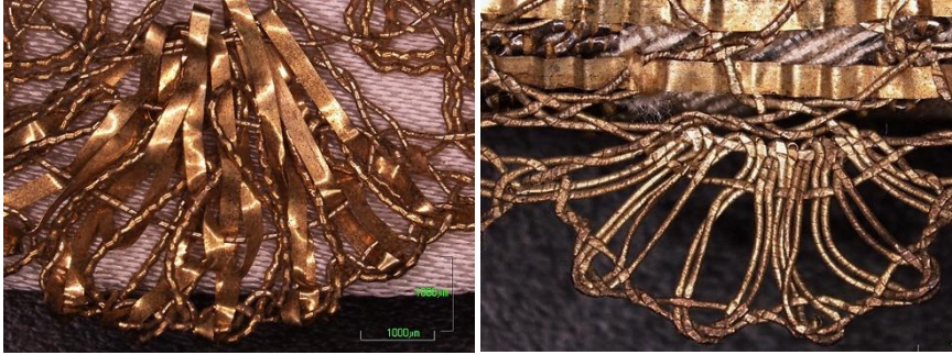
Figura 254. Imágenes con ME de encajes metálicos dorados elaborados con hilos metálicos y hojuelas.
