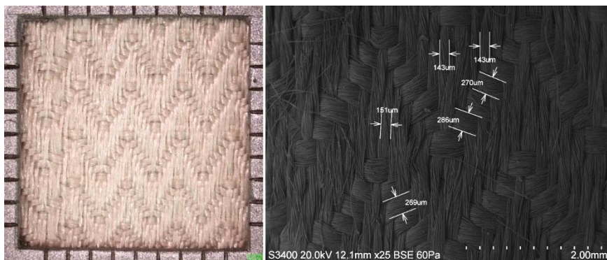
Figura 176. Imágenes con ME y SEM con electrones retrodispersados del tejido de forro de sarga espiguilla “Chevron”, sentido urdimbre, empleado en la confección de los dos conjuntos de vestiduras de la Virgen confeccionados en Roma a finales del siglo XVIII.
