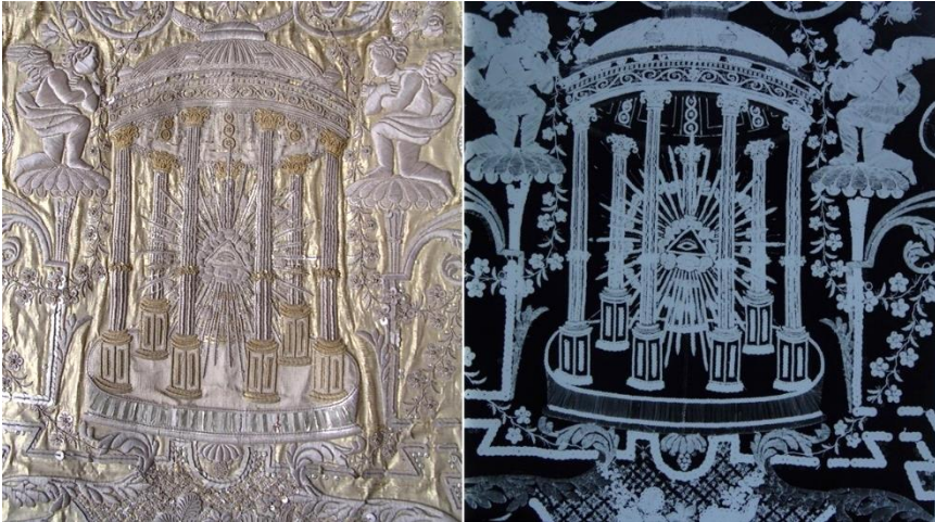
Figura 328. Imágenes con luz visible y radiográfica del bordado de la escena central del vestido.
