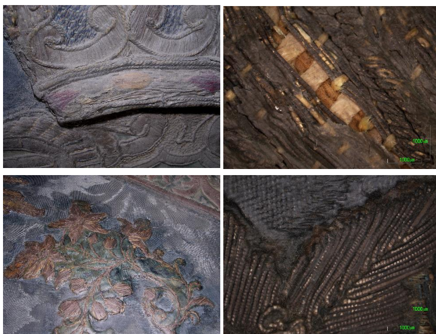
Figura 466. Ejemplos de uso de adhesivo vinílico. Detalles e imágenes ME de los Estandartes del Regimiento de Caballería de Cartagena en lo que se aprecia el apelmazamiento y roturas generado por el adhesivo aplicado
