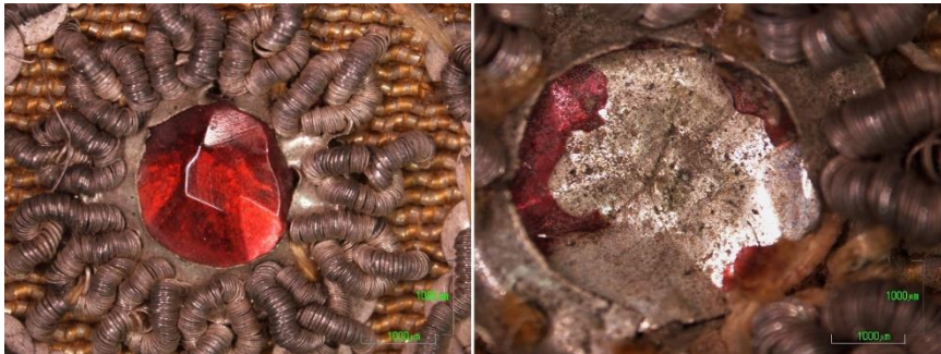
Figura 203. Imágenes con ME de elementos de joyería con espejuelos de color rojo y detalle de pérdida del vidrio donde se aprecian restos del metal coloreado rojo.
