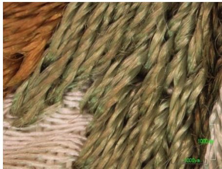
Figura 197. Imagen con ME de hilaturas de bordados formadas por hilos de dos cabos.
