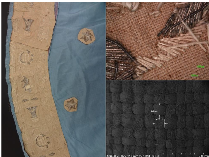
Figura 178. Imágenes con ME y SEM del tejido de tafetán empleado como entretela de refuerzo en las áreas bordadas en la capa de la Real Orden de Carlos III .
