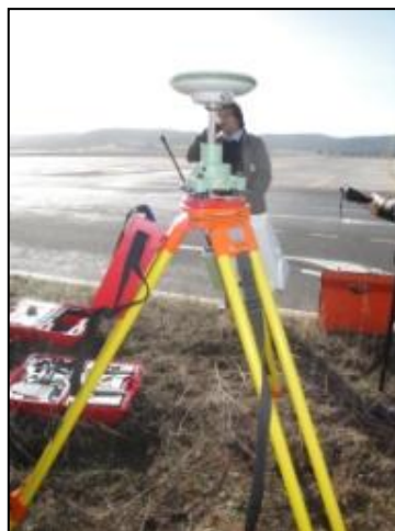
Fig 111. Base fija para posicionamiento RTK [fuente propia].
