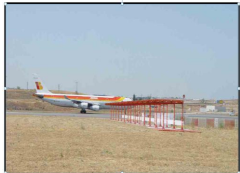
Fig 14. Imagen de radiobalizas de ILS [fuente:AENA].
