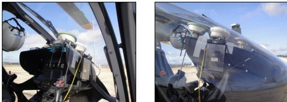
Fig 107. Detalle de montaje de antenas en el helicóptero [fuente propia].
