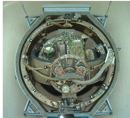
Fig 21. Sistema inercial [Fuente ASC].
