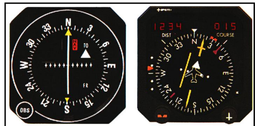
Fig 8. Indicador VOR de pilotaje [fuente:AENA]
