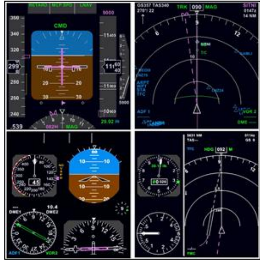
Fig 93. Ejemplo de un EFIS. [fuente. Eurocopter]
