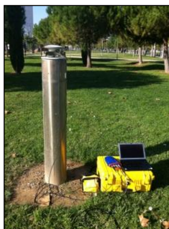
Fig 101. Observación estática en pilar de centrado forzoso. [fuente propia]
