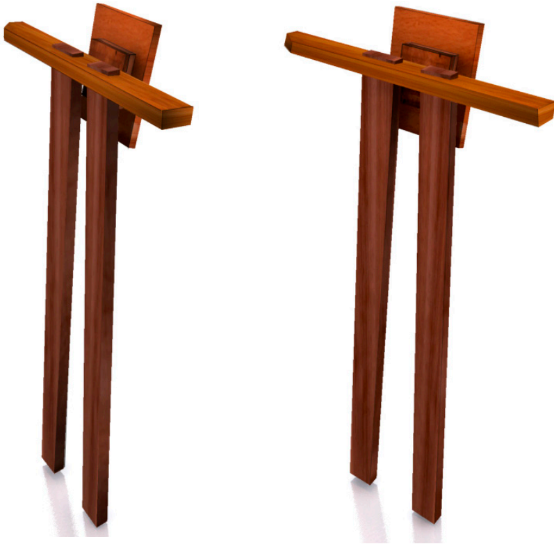
Figura 322-323. Diferentes vistas de la renderización de la estructura de soporte del cuerpo del San Miguel Arcángel .
