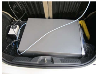
Figura 17. Suministro de energía (izquierda), y equipo de medida de la estación de monitoreo móvil (derecha).
