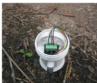
Fotografía 5. Detalle de la sonda Diviner 2000 utilizada para el cálculo de las necesidades de riego.
