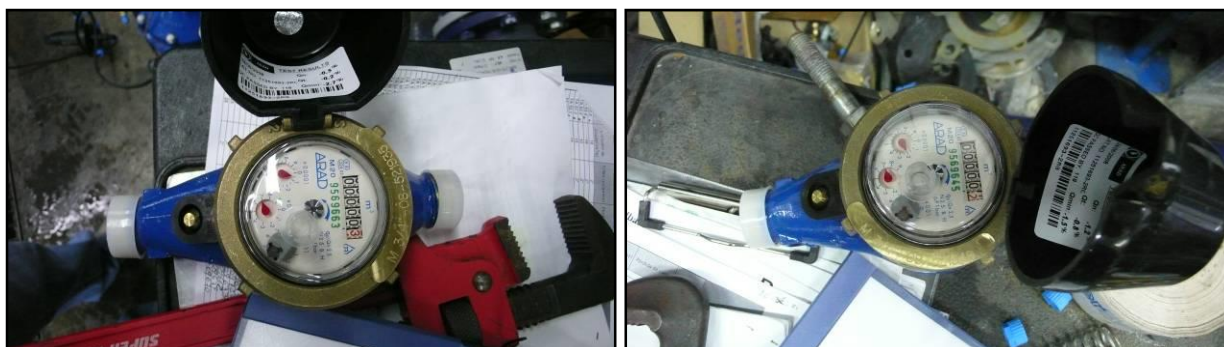
Fotografía 55: Contador DN 20. Modelo MJ 3/4 N° Serie 08-521935 y 08-521948.
