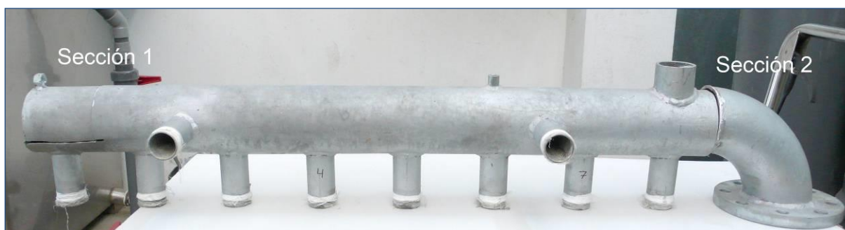
Fotografía 32: Hidrante 7. Colector completo
