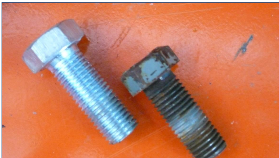
Fotografía 13: Hidrante 2. Corrosión y no uniformidad en los tornillos de apriete de la tapa del filtro caza piedras.
