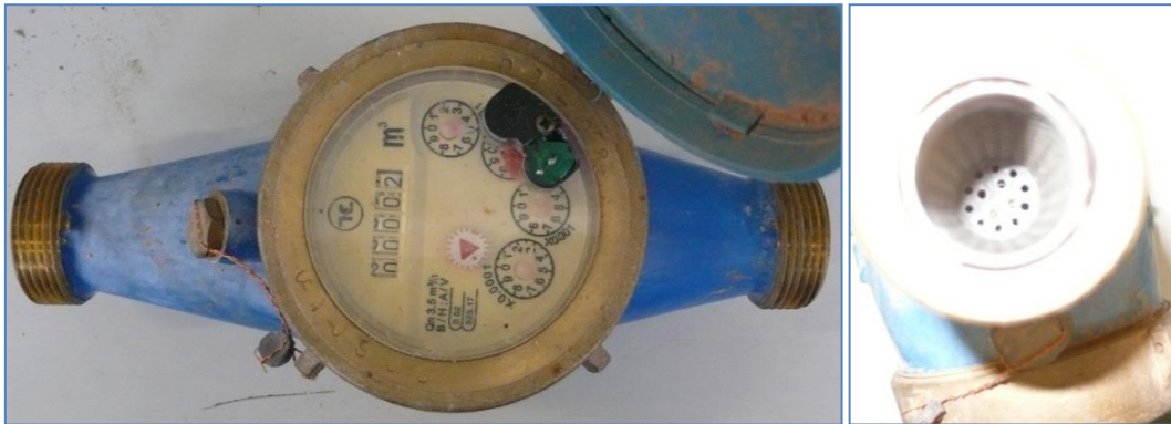
Fotografía 62: Estado exterior contador 25B. Presenta restos de obturación en el filtro.
