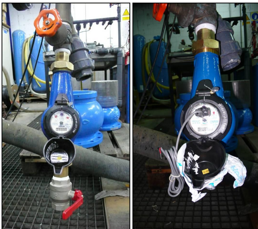
Fotografía 54: Contador DN 40. Modelo MS 1"1/2 N° Serie 06-63272 y 10-76116 en posición vertical
