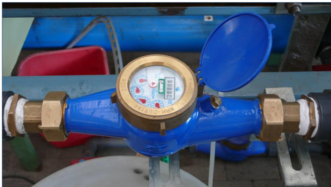
Fotografía 50: Contador Wehrle Modelo RMM en posición horizontal
