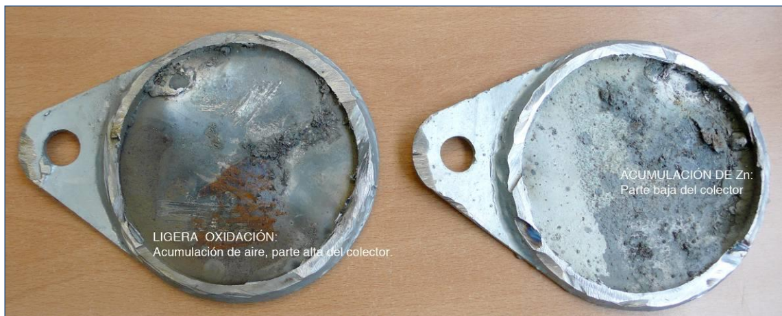
Fotografía 10: Hidrante 2. Estado interior zona seccionada. Detalle de corrosión y acumulación de Zn.
