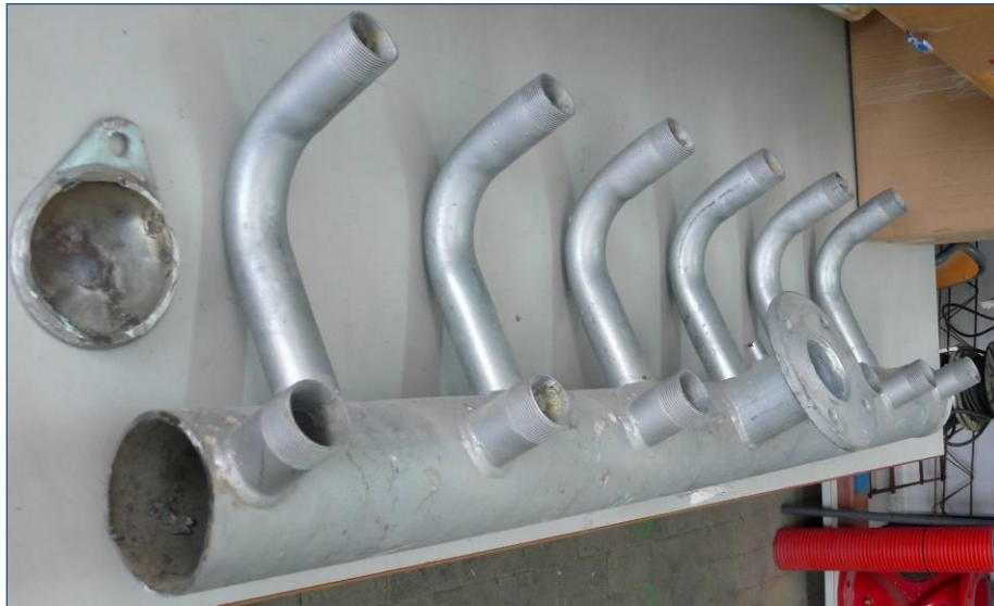
Fotografía 8: Hidrante2. Colector completo
