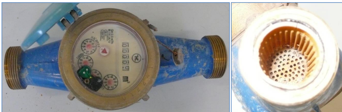
Fotografía 60: Estado exterior contador 30I. Presenta restos de obturación en el filtro.
