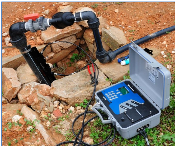
Fotografía 68: Detalles instalación en Toma 40 mm. Instalación en parcela.
