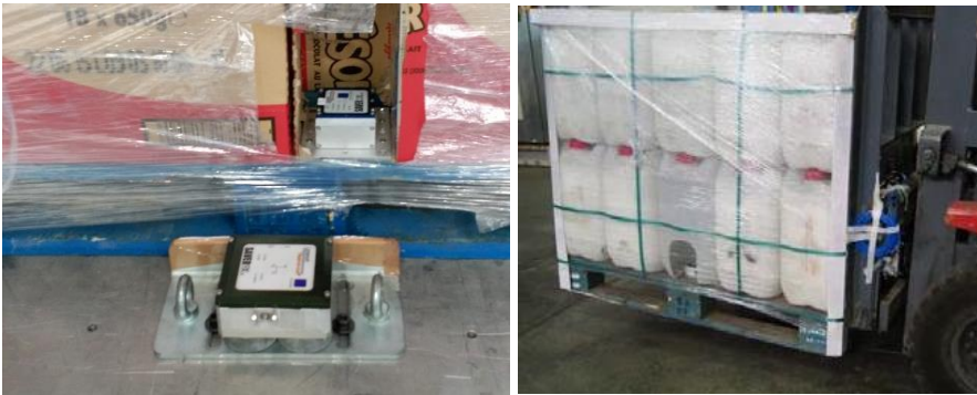
Figura 19. Anclaje del dispositivo de monitorización 1) En la estructura del vehículo 2) En la unidad de carga a monitorizar
