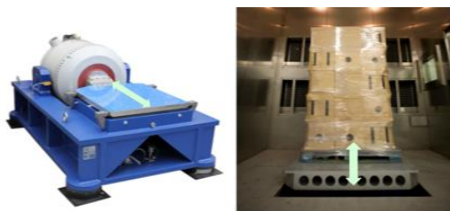
Figura 28. Equipos para ensayos de vibración 1) electromagnético 2) hidráulico
