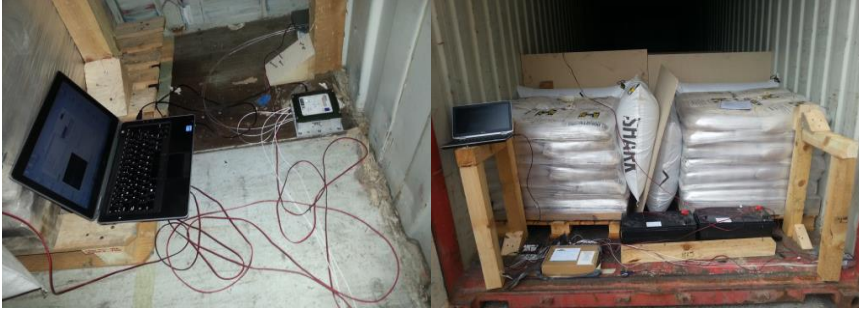
Figura 39. Instalación de los registradores de vibraciones en el contenedor
