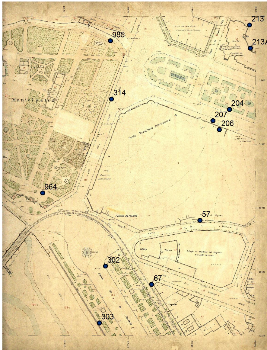
Figura 5.11: Detalle de los 12 vértices empleados para calcular el umbral de precisión de la transformación (I)
