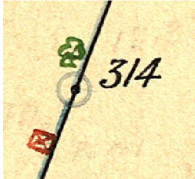
Figura 5.10: Vértice de una poligonal definido por un punto negro cuyo diámetro es de 38 mm
