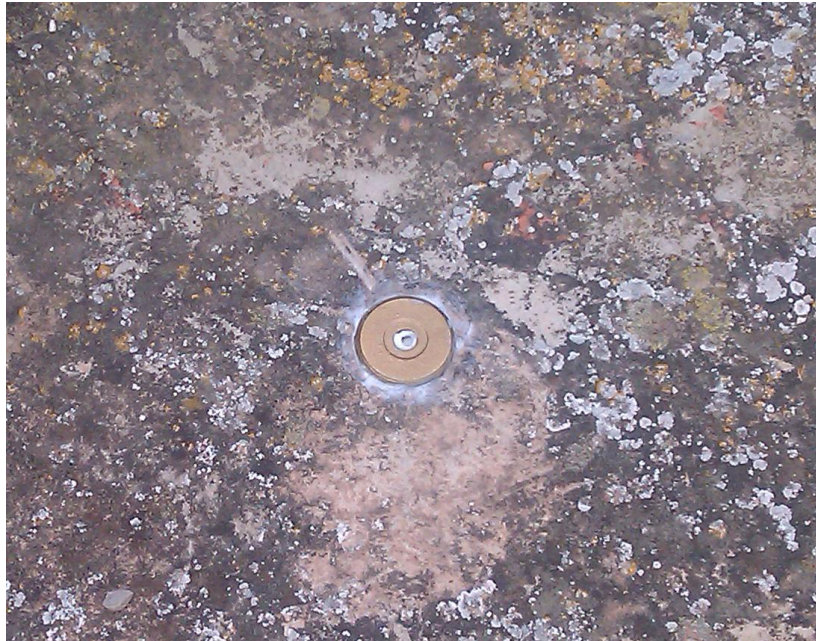
Figura 2.46: Vértice Almacera replanteadado sobre el pavimento de la Torre Norte de la Iglesia
