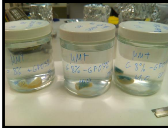
Figura 23: Pots de vidre etiquetats plens de etanol fred amb les plantilles congelades al interior
