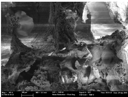
Figura 63: Vista de la secció dels scaffolds de gelatina amb PLLA en proporcions 50/50.
