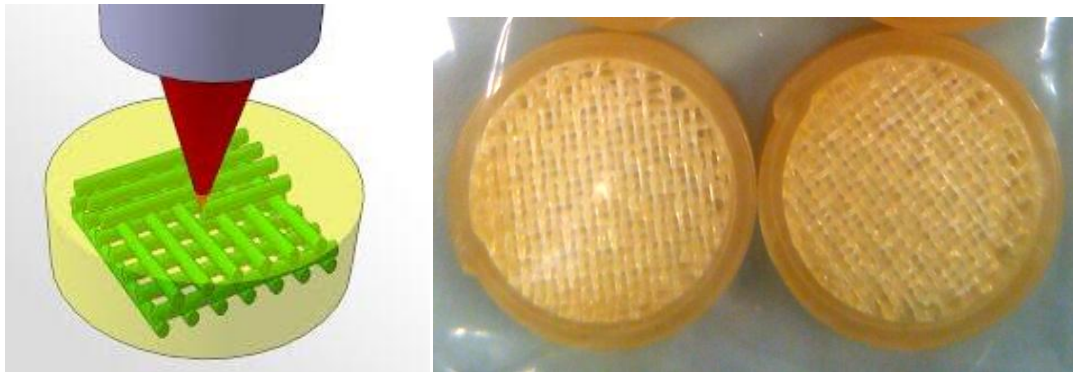
Figura 20: Procés de impressió de la plantilla de PVA (esquerre); plantilles de PVA impreses (dreta)
