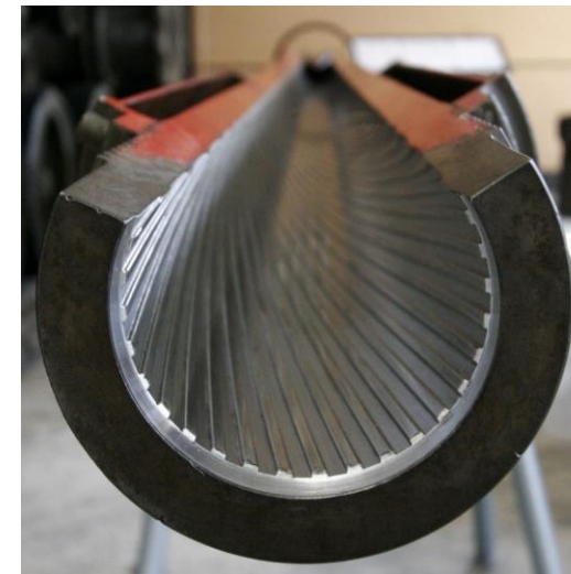
13. Ánima estriada en cañón moderno
