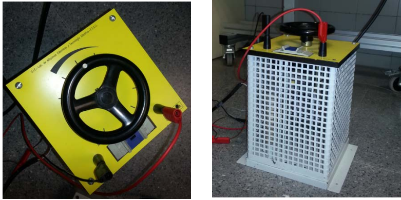
Figura 4-04. Imagen representativa de banco de resistencia variable utilizado en el ensayo de desequilibrio entre fases.
