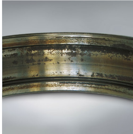
Figura 2-10. Pista externa de rodamiento con corrosión.
