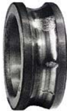
Figura 2-09. Pista interna de rodamiento con desconchado.
