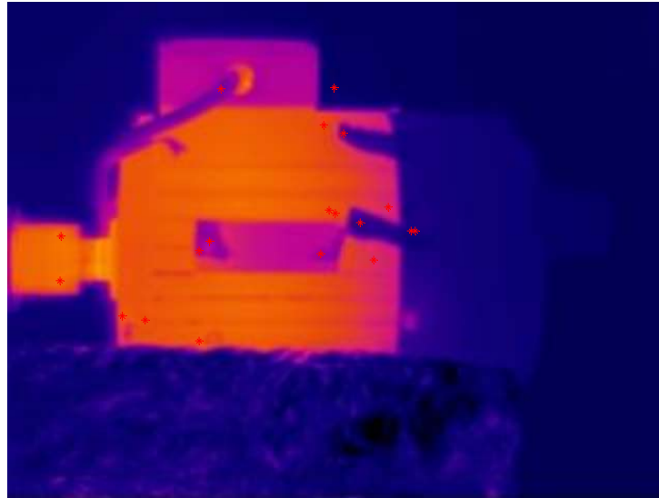
Figura 6-03. Representación de keypoints con forma de estrella en la imagen termográfica.
