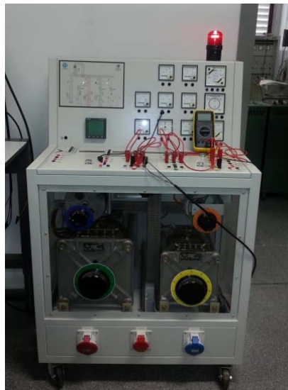
Figura. 3-10. Pupitre de alimentación eléctrica utilizado en los ensayos.
