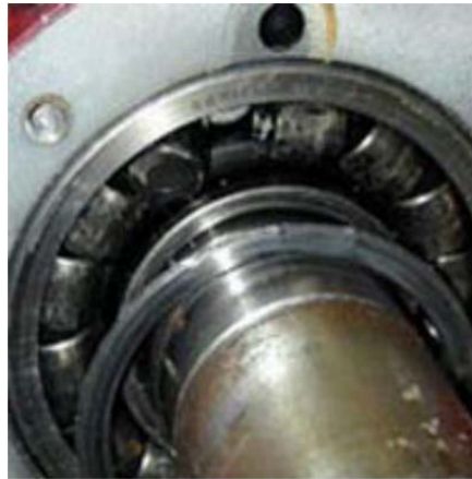
Figura 2-12. Rodamiento con jaula de retención averiada.
