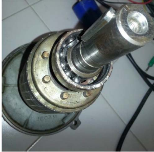
Figura 4-02. Imagen representativa de fallo de rodamientos.
