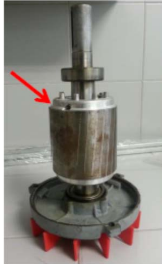
Figura 4-03. Imagen representativa de fallo de barras rotas.
