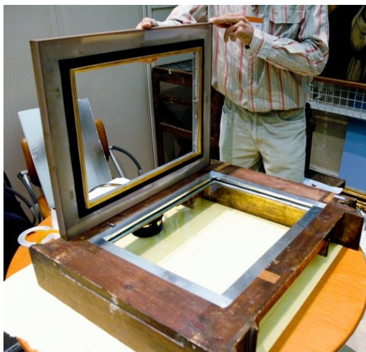
Imagen 54. Imagen de una caja climática interna, donde el marco original se mantiene. Fuente: Pagina web S.I.T. Spain.
