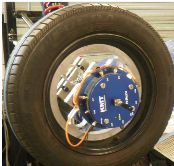
Figura 5.5. Rueda dinamométrica para medida de fuerzas
