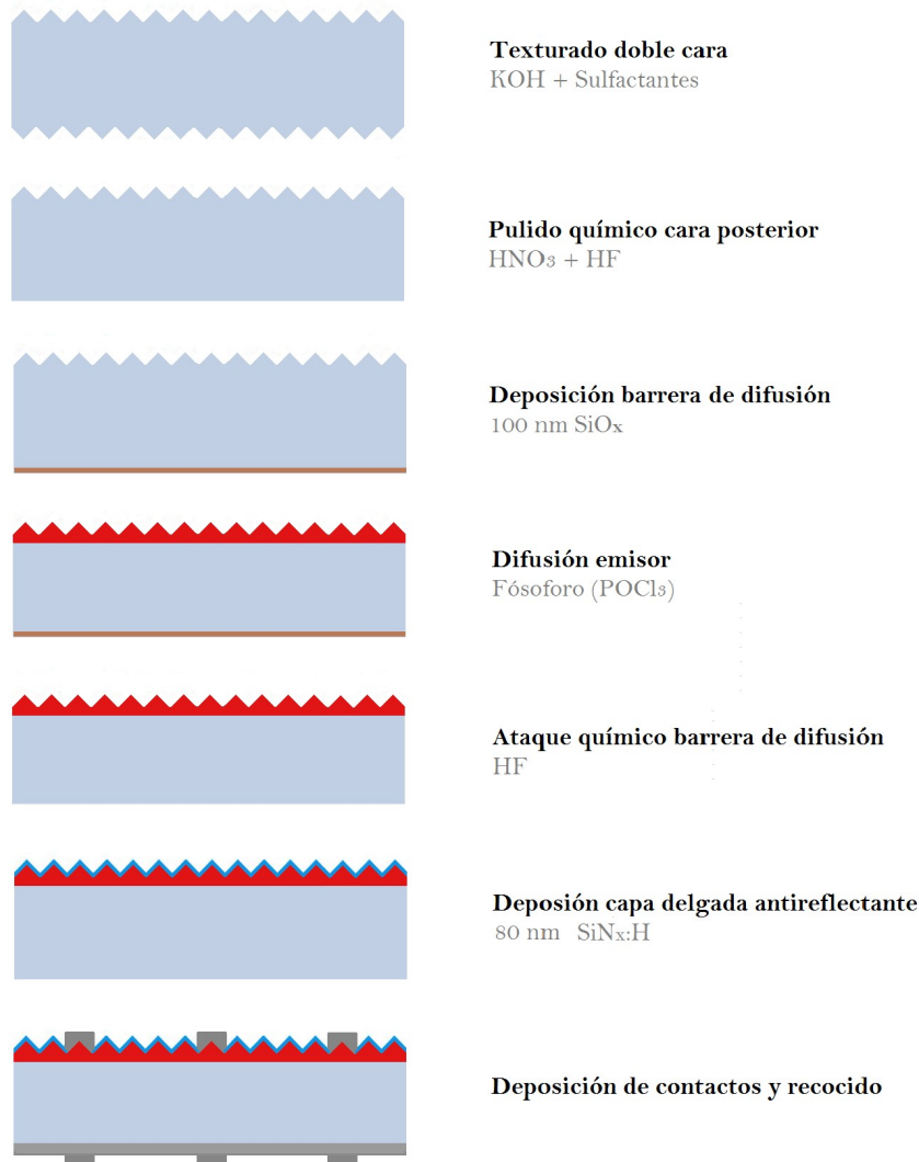
Figura 71. Diagrama mostrando las principales etapas de proceso utilizadas en la fabricación de las células con estructura Al-BSF.
