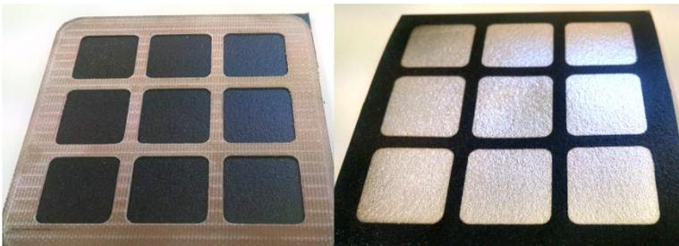
*Figura 68. Izquierda muestra con máscara para ser metalizada, derecha muestra metalizada [ep].*
