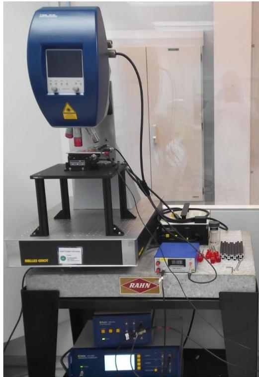
*Figura 66. Foto de montaje de MMA-400 Micro Motion Analyzer para medida inversa de  $d_{33}$  [ep].*
