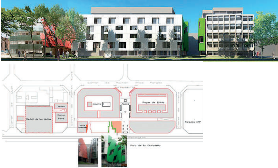
Figs. 247 y 248. Plano de emplazamiento y alzado con la conexión entre los edificios.
