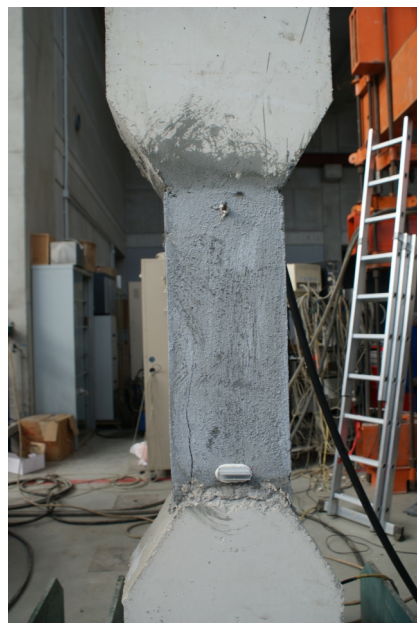
Figura 73 - Pilar PR4C_R3 tras el ensayo a compresión. Fisuración caras C1 y C3 respectivamente.
