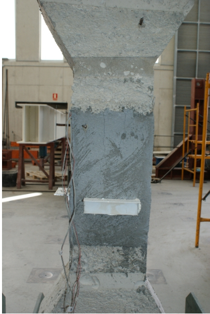
Figura 153 - Pilares PRP_R3 tras el ensayo a compresión. Fisuración caras C1 y C3 respectivamente.
