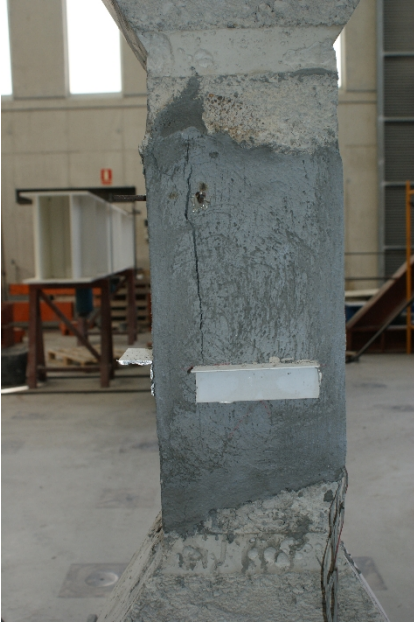
Figura 143- Pilares PRP_R3+PU tras el ensayo a compresión. Fisuración caras C1 y C3 respectivamente.
