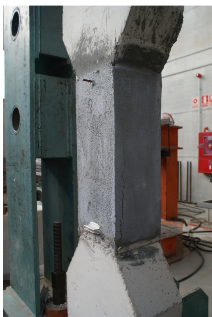
Figura 74 - Pilar PR4C_R3 tras el ensayo a compresión. Fisuración de las caras laterales, caras C2 y C4 respectivamente.
