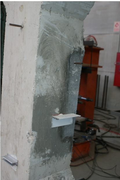
Figura 144 - Pilares PRP_R3+PU tras el ensayo a compresión. Fisuración caras laterales C2 y C4 respectivamente.
