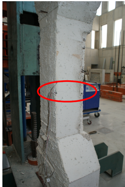
Figura 91 - Pilares PPD1C tras el ensayo a compresión. Fisuración caras C2 y C4 respectivamente.
