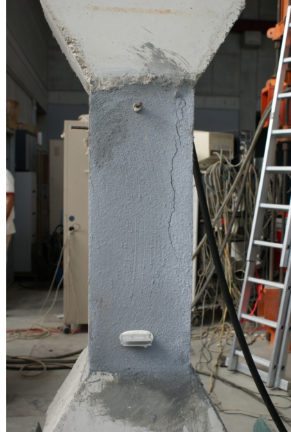
Figura 128 - Pilares PR1C_R4 tras el ensayo a compresión. Fisuración caras C1 y C3 respectivamente.
