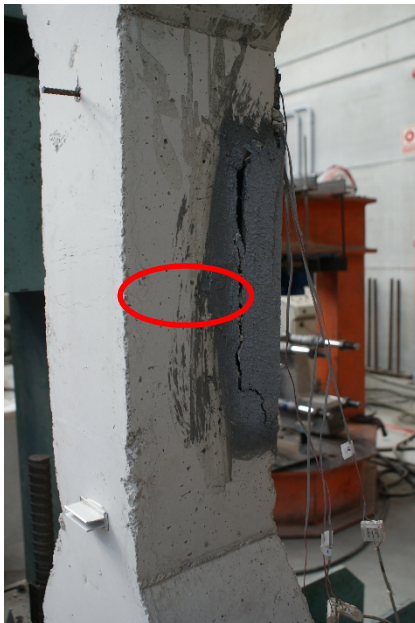
Figura 172 - Pilares PRP_R4 tras el ensayo a compresión. Fisuración caras laterales C2 y C4 respectivamente.
