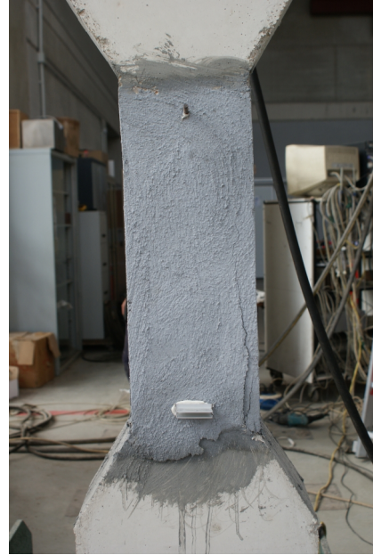
Figura 85 - Pilares PR4C_R4 tras el ensayo a compresión. Fisuración caras C1 y C3 respectivamente.
