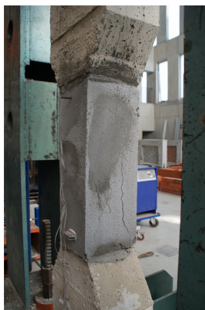
Figura 74 - Pilar PR4C_R3 tras el ensayo a compresión. Fisuración de las caras laterales, caras C2 y C4 respectivamente.
