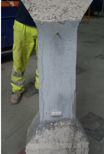
Figura 79 - Pilares PR4C_R4+PU tras el ensayo a compresión. Fisuración caras C1 y C3 respectivamente.
