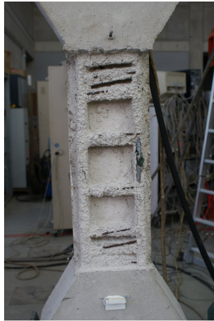
Figura 90 - Pilares PPD1C tras el ensayo a compresión. Fisuración caras C1 y C3 respectivamente.
