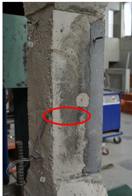
Figura 129 - Pilares PR1C_R4 tras el ensayo a compresión. Fisuración caras C2 y C4 respectivamente.
