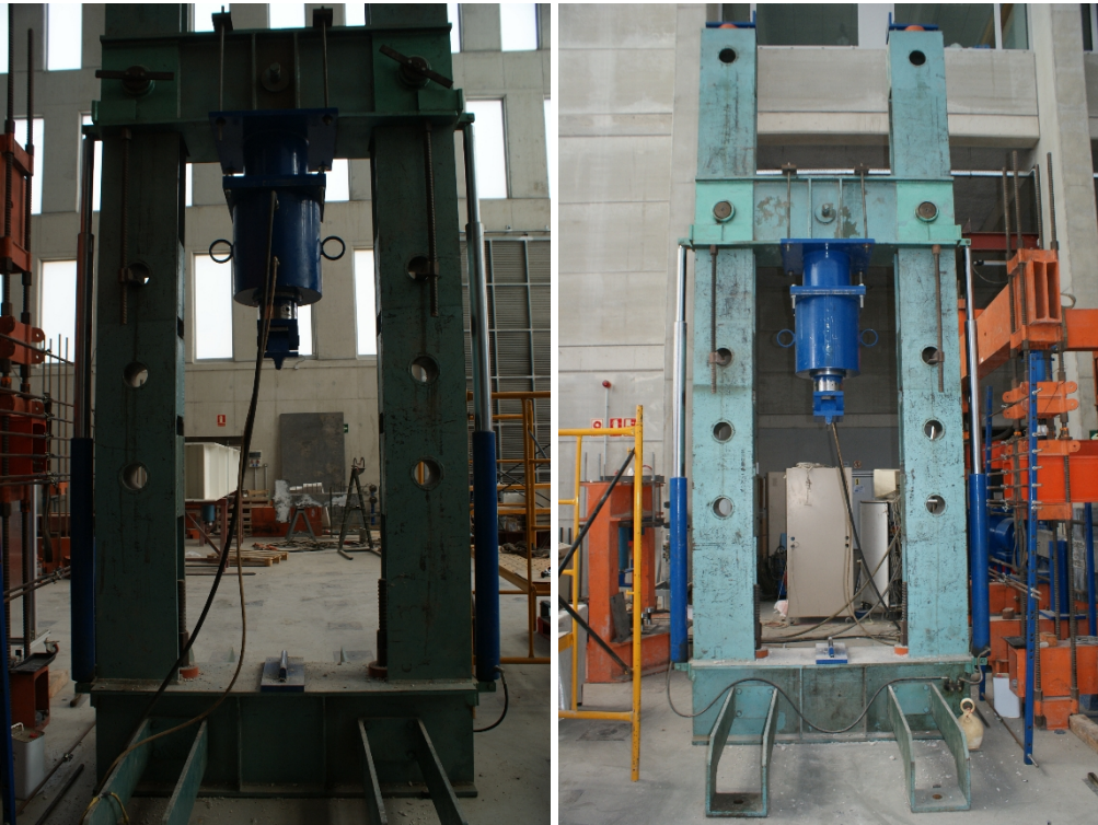
Figura 52. Fotografías del pórtico de ensayo.
