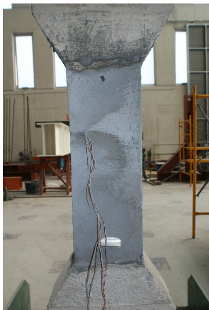
Figura 73 - Pilar PR4C_R3 tras el ensayo a compresión. Fisuración caras C1 y C3 respectivamente.
