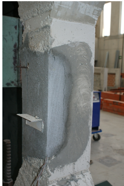
Figura 144 - Pilares PRP_R3+PU tras el ensayo a compresión. Fisuración caras laterales C2 y C4 respectivamente.
