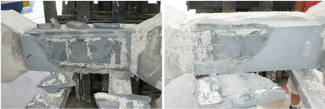
Figura 120 - Pilares PR1C_R4+PU tras el ensayo a compresión. Detalle del desprendimiento de la capa de reparación tras el ensayo.
