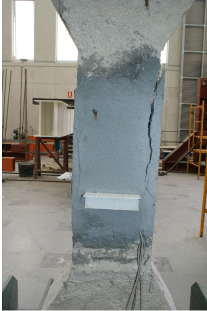
Figura 171 - Pilares PRP_R4 tras el ensayo a compresión. Fisuración caras C1 y C3 respectivamente.
