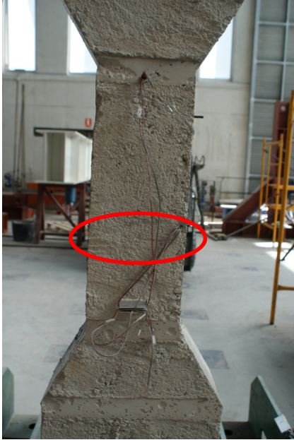
Figura 128 - Pilares PR1C_R4 tras el ensayo a compresión. Fisuración caras C1 y C3 respectivamente.
