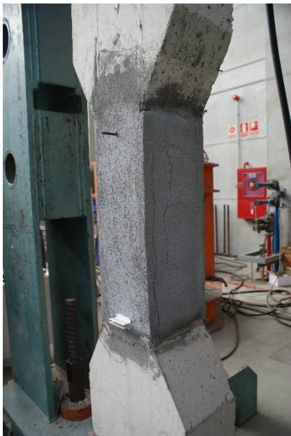
Figura 68 - Pilar PR4C_R3+PU tras el ensayo a compresión. Fisuración caras laterales, caras C2 y C4 respectivamente.
