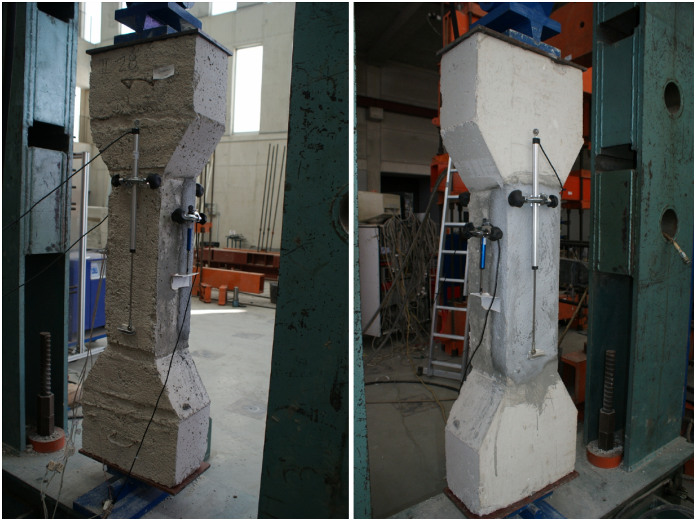
Figura 57- Colocación de la instrumentación en los pilares a 1 cara, Cara C1-C4 y C3 respectivamente.
