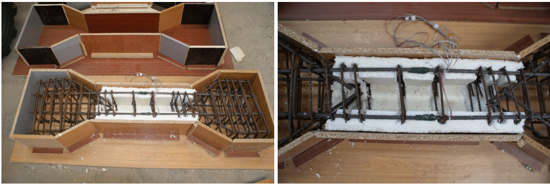
Figura 29 - Pilar daño en las 4 caras, encofrado.
