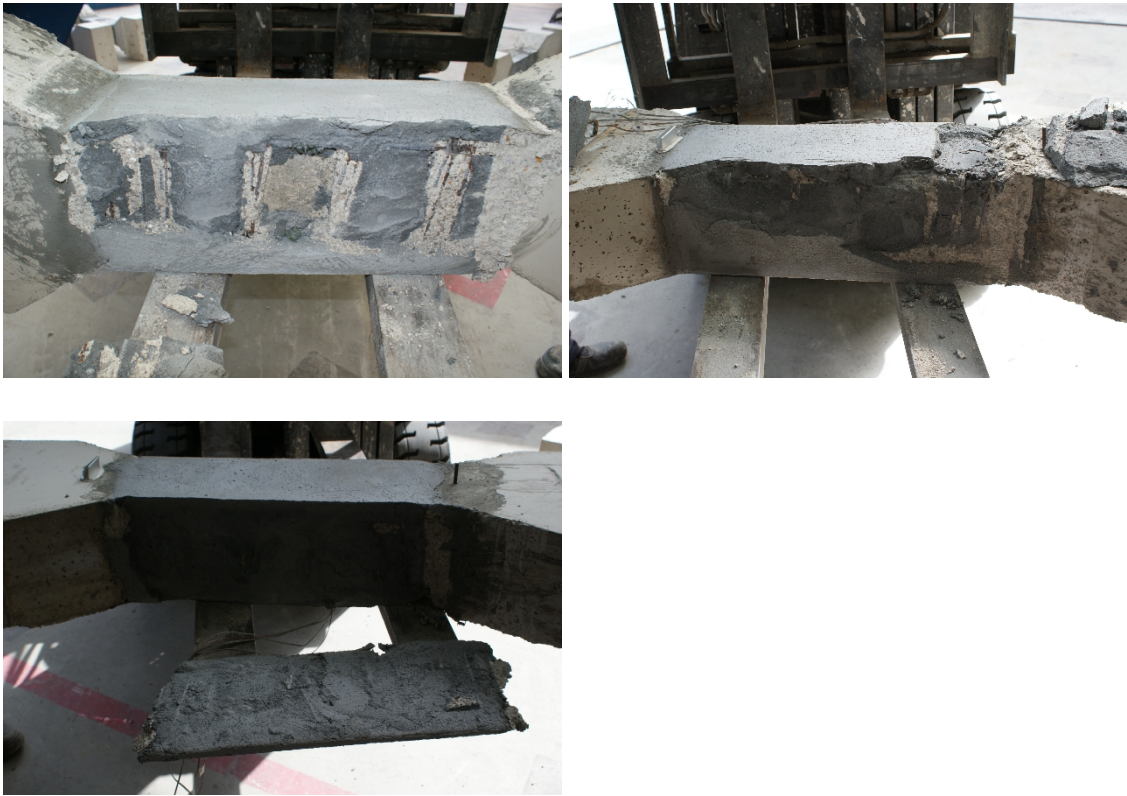
Figura 75 - Pilar PR4C_R3 tras el ensayo a compresión. Detalle del desprendimiento de la capa de reparación tras el ensayo.
