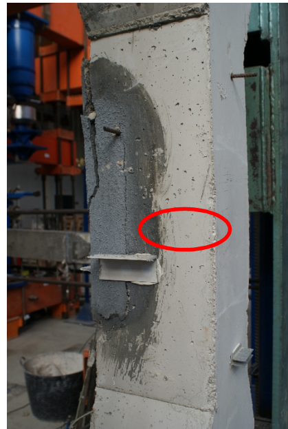
Figura 172 - Pilares PRP_R4 tras el ensayo a compresión. Fisuración caras laterales C2 y C4 respectivamente.
