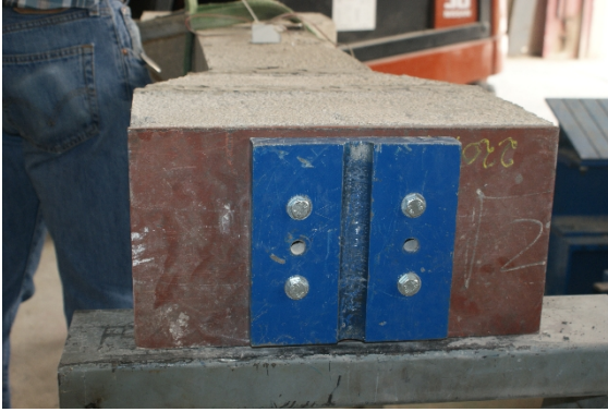
Figura 20 – Fotografía del detalle de las placas de reparto.
