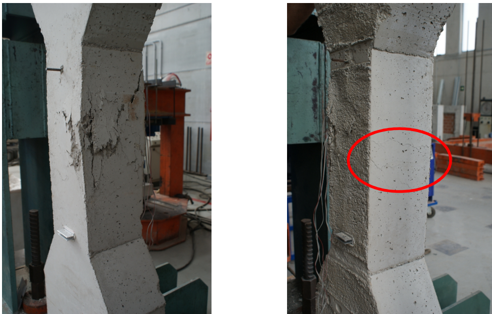
Figura 59 - Pilares PP tras el ensayo a compresión. Fisuración cara laterales (Cara C2 y Cara C4).
