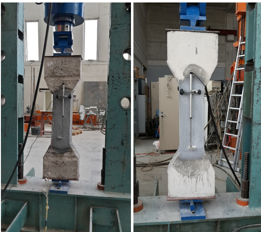
Figura 56- Colocación de la instrumentación en los pilares a cuatro caras, Cara C1 y C3 respectivamente.
