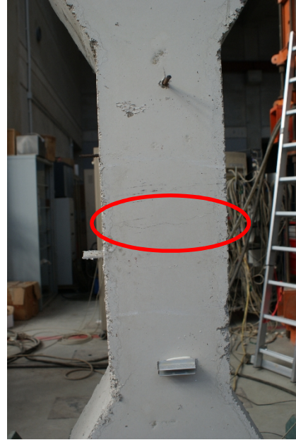
Figura 171 - Pilares PRP_R4 tras el ensayo a compresión. Fisuración caras C1 y C3 respectivamente.
