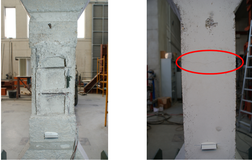
Figura 137 - Pilares PPDP tras el ensayo a compresión. Fisuración caras C1 y C3 respectivamente.
