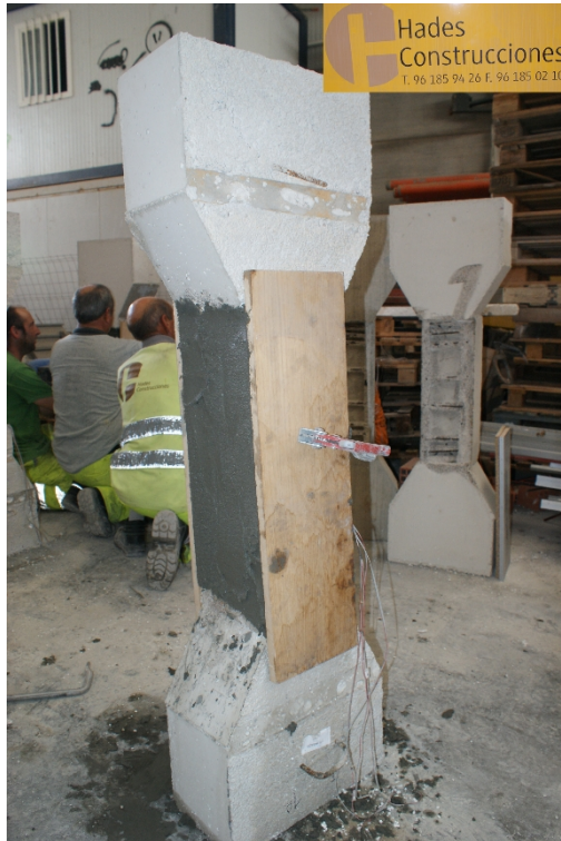
Figuras 45 y 46 - Encofrado a dos caras, relleno del resto del espesor.
