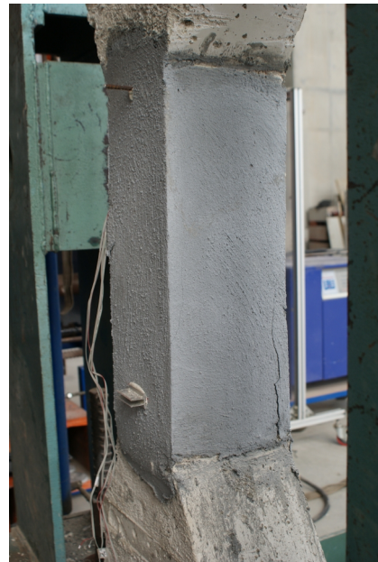
Figura 86 - Pilares PR4C_R4 tras el ensayo a compresión. Fisuración caras C2 y C4 respectivamente.
