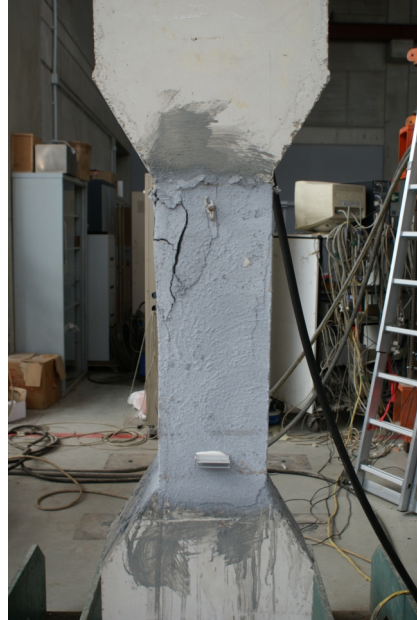
Figura 79 - Pilares PR4C_R4+PU tras el ensayo a compresión. Fisuración caras C1 y C3 respectivamente.
