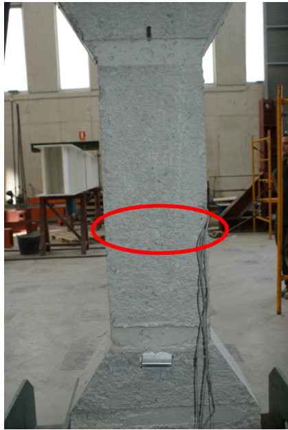
Figura 90 - Pilares PPD1C tras el ensayo a compresión. Fisuración caras C1 y C3 respectivamente.
