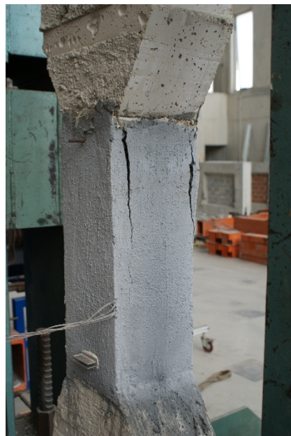
Figura 80 - Pilares PR4C_R4+PU tras el ensayo a compresión. Fisuración caras C2 y C4 respectivamente.
