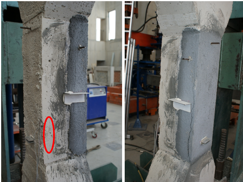
Figura 119 - Pilares PR1C_R4+PU tras el ensayo a compresión. Fisuración cara lateral C4.
