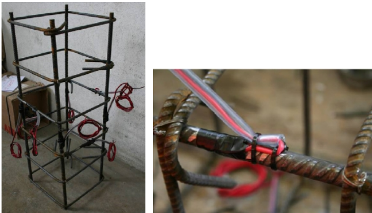
Figura 14 – Instrumentación de las armaduras, da Porto et al. (2012).
