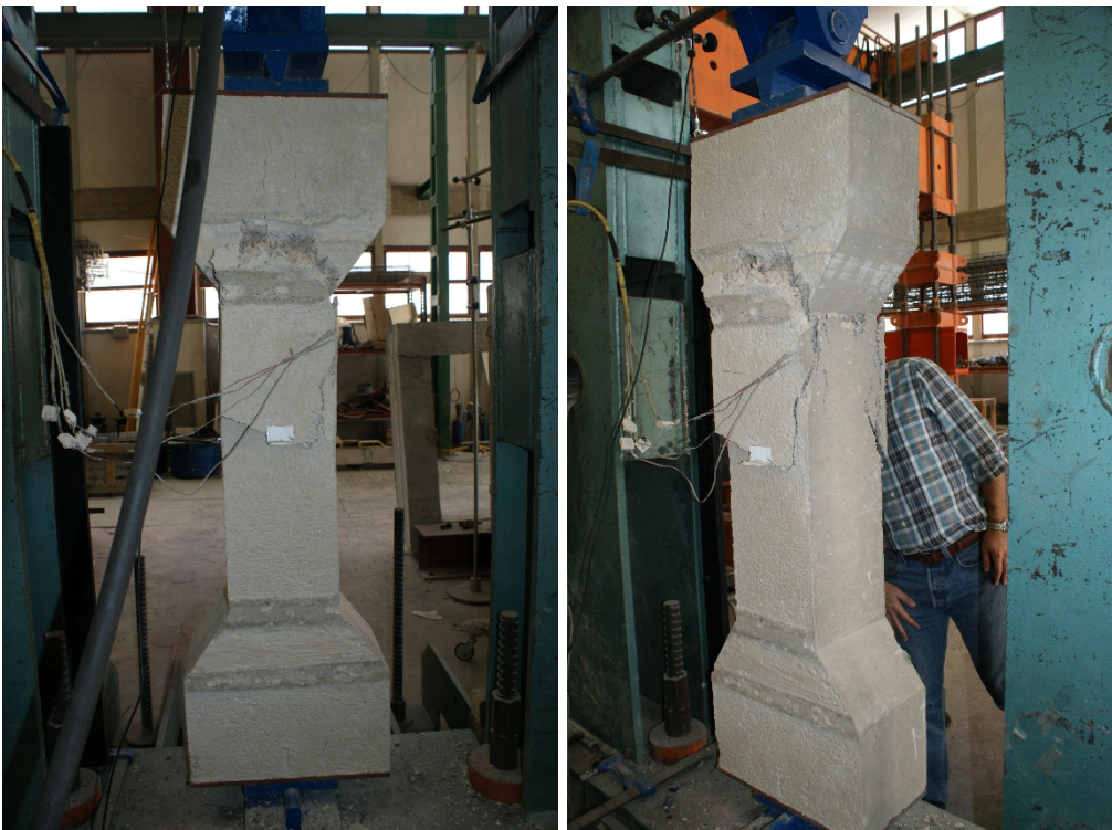
Figura 21 – Fotografías rotura del pilar previo.
