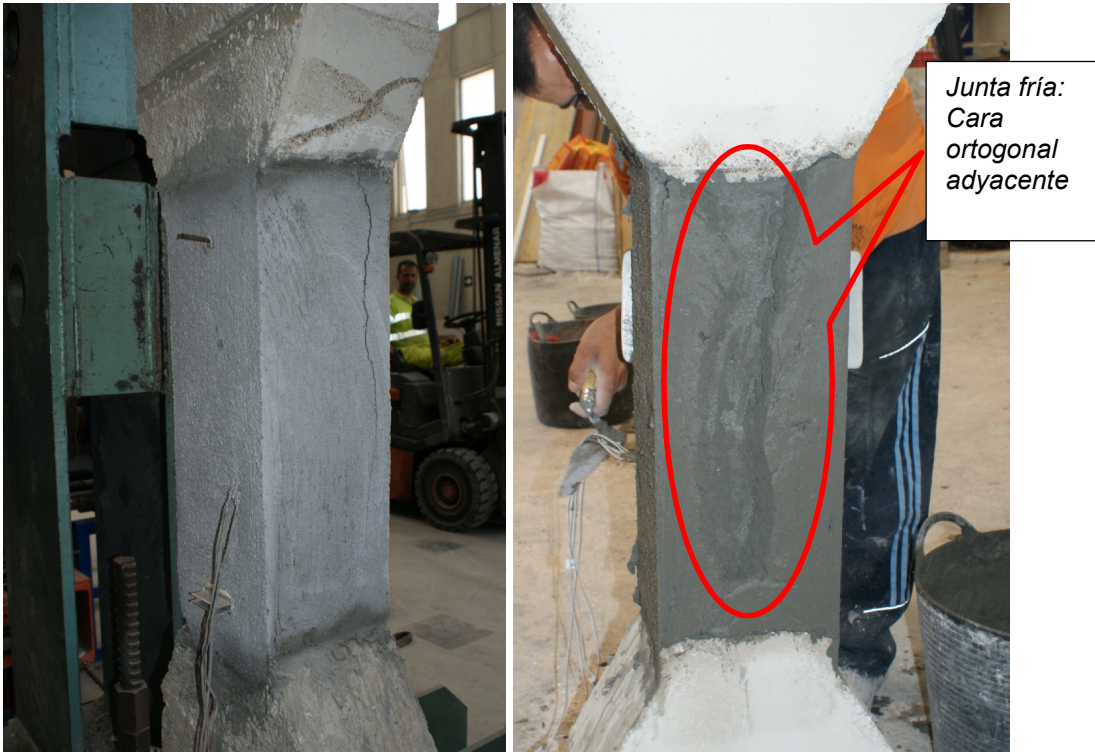
Figura 182. a) Detalle del fallo en las juntas frías tras el ensayo. b) detalle de la formación de la junta fría entre las caras ortogonales adyacentes, durante la reparación.
