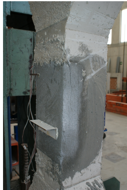
Figura 154 - Pilares PRP_R3 tras el ensayo a compresión. Fisuración caras laterales, C2 y C4 respectivamente.
