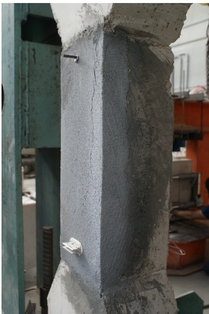
Figura 129 - Pilares PR1C_R4 tras el ensayo a compresión. Fisuración caras C2 y C4 respectivamente.
