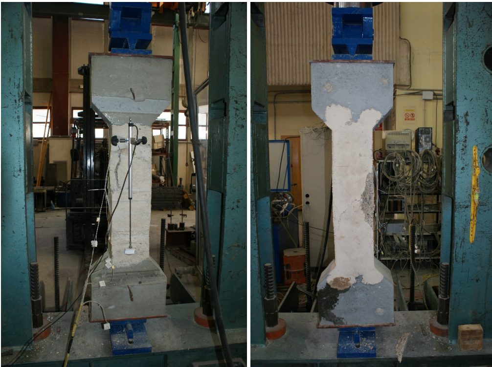
Figura 25 – Detalle rotura pilar hormigonado en dos veces (cabeza y zona central).
