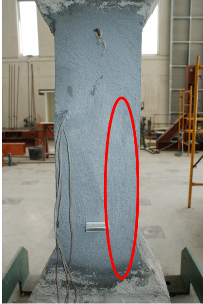
Figura 85 - Pilares PR4C_R4 tras el ensayo a compresión. Fisuración caras C1 y C3 respectivamente.
