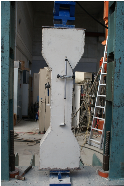
Figura 55- Colocación de la instrumentación en los pilares de parcheo, Cara C3
