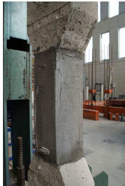
Figura 68 - Pilar PR4C_R3+PU tras el ensayo a compresión. Fisuración caras laterales, caras C2 y C4 respectivamente.
