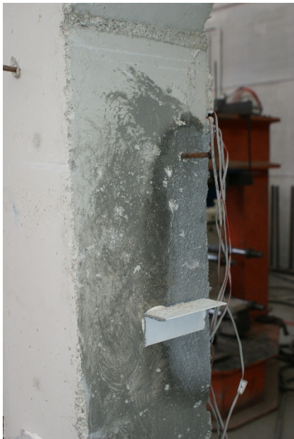
Figura 154 - Pilares PRP_R3 tras el ensayo a compresión. Fisuración caras laterales, C2 y C4 respectivamente.
