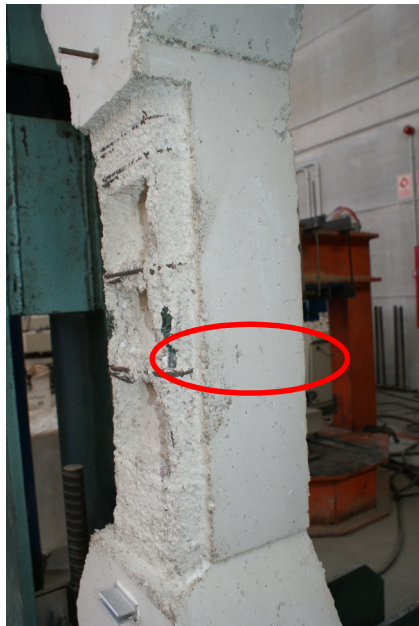
Figura 91 - Pilares PPD1C tras el ensayo a compresión. Fisuración caras C2 y C4 respectivamente.
