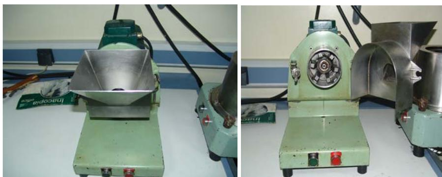
**Figura 79. Molino de martillos empleado en la molturación de las aceitunas.**
