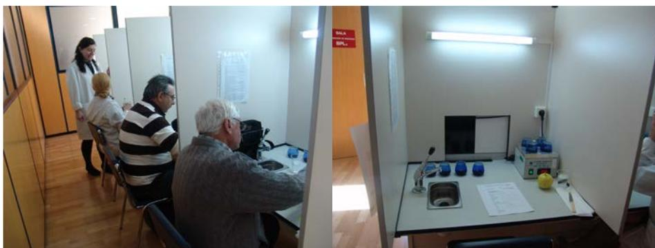
**Figura 86. Sala de cata y cabina individual para el análisis sensorial de los aceites de oliva.**
