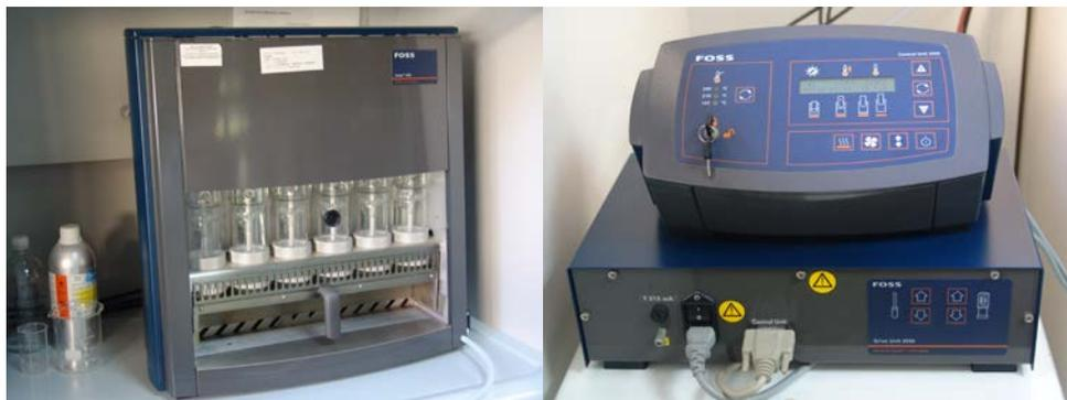
**Figura 82. Equipo Soxtec Avanti 2050 para la determinación del rendimiento de grasa.**
