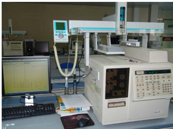
**Figura 84. Equipo de cromatografía de gases Varian.**
