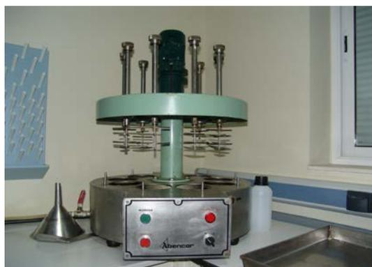
**Figura 80. Termobatidora en el procesamiento de la pasta de aceitunas.**
