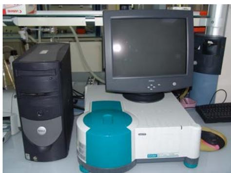
Figura 83. Espectrofotómetro Varian CARI-50 para la determinación de la prueba en el ultravioleta.
