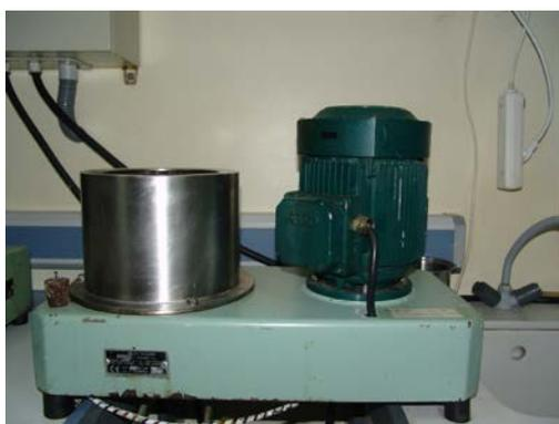
**Figura 81. Centrífuga para el procesamiento de la pasta de aceitunas.**
