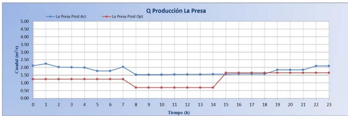
Figura. 8.36. Caudal de producción para la Planta de La Presa (act: azul)/ (opt: rojo).
