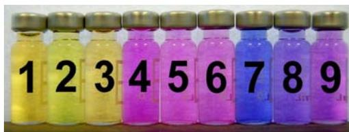
Figura 4.6. Fotografía de viales conteniendo disoluciones acuosas ( $10^{-5}$  M, pH 5.5) de PR (1-3), PY (4-6) y TI (7-9) en ausencia (1,4,7) y presencia de CB[7] (2,5,8) o CB[8] (3,6,9).
