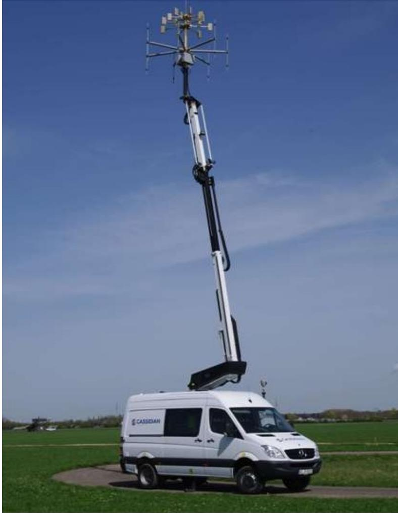
*Figura 4.1. Ejemplo radar pasivo. Diseñado por Airbus Defence.*
