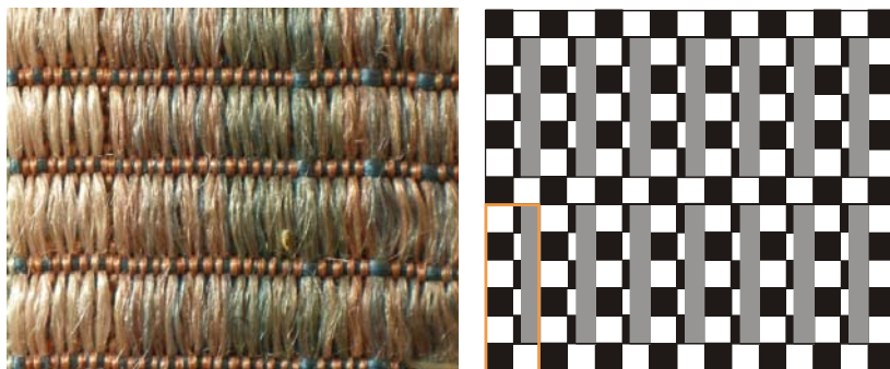
Figura 60 – Falle francesa - muestra textil y representación gráfica del ligamento. Foto: Antonio Fernando.
