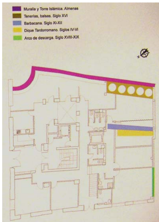
-Planimetría y esquema básico de los restos hallados en la intervención, coincidiendo la muralla con le medianera del edificio (Archivo SIAM).
