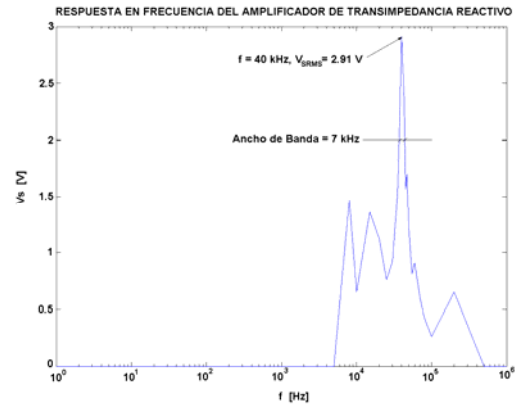
Figura 12. Registro de la respuesta en frecuencia del amplificador de transimpedancia del fotodiodo PIN.
