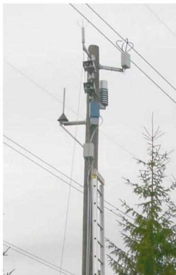
Figura 2-2. Fotografía de un sistema de información del clima en carretera (“Road/Runway Weather Information System—RWIS”). Tomada de [2].
