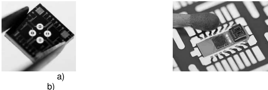
Fig. 1. a) Fotomicrografía de un microsensado para detectar contaminantes mediante la técnica del microsistema. Tomado y adaptado de [4]. b) Fotografía de un acelerómetro mediante la técnica del micromódulo. Tomado y adaptado de [5].
