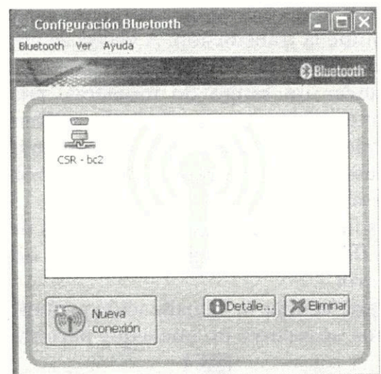
Fig. 20. Aspecto de la GUI del dispositivo Bluetooth comercial cuando ya se ha conectado al módulo BlueCore02.
