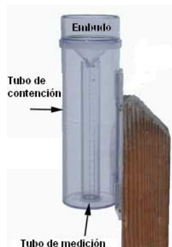
Figura 2-14. Fotografía que muestra un medidor de lluvia por medición de nivel. (Tomado y adaptado de [33]).
