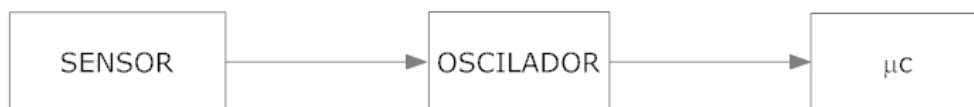
Figura 2-29. Diagrama a bloques de un circuito interfaz sensor/microcontrolador basado en un oscilador.
