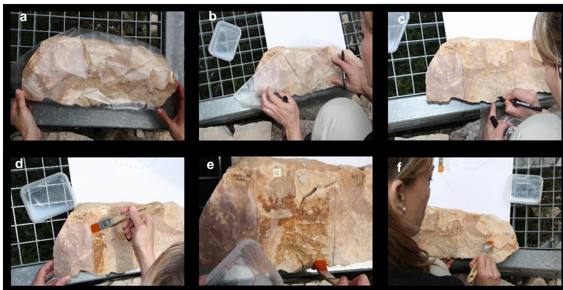
Figura 247 (a, b, c, d, e, f). Preparación en Cova Remígia (Ares del Maestre-Castellón), de las probetas pertenecientes al grupo C ( in situ ), destinadas al ensayo de Envejecimiento natural .
