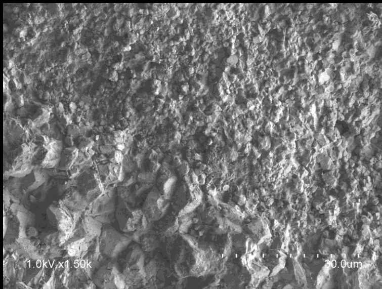
Figura 343. Detalle de la Probeta 13 N, tras los ciclos de envejecimiento acelerado.
