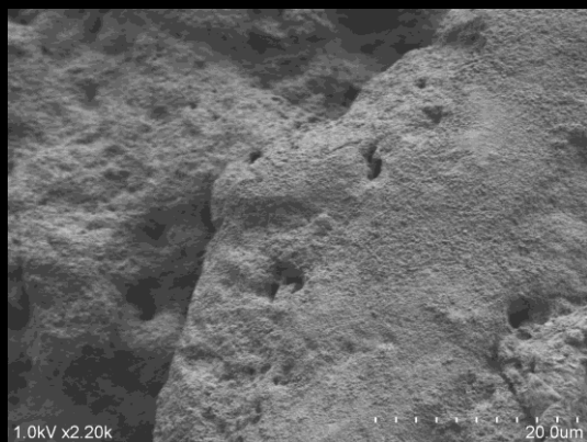
Figura 369. Detalle de la distribución superficial de las nanopartículas de CaLoSiL E25 grey® . Probeta 19 E25g con 3 capas de producto.
