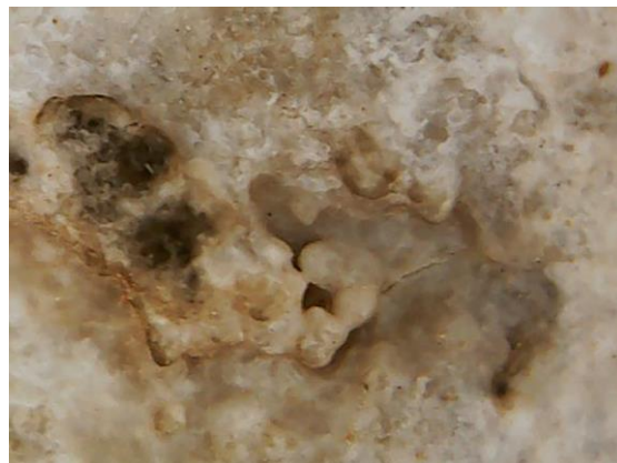
Figura 146. Bioalteración de la superficie pétreo de Cova Remígia, y costras de carbonato cálcico. Imagen realizada con microscopio portátil DigiMicroscope USB reflecta .
