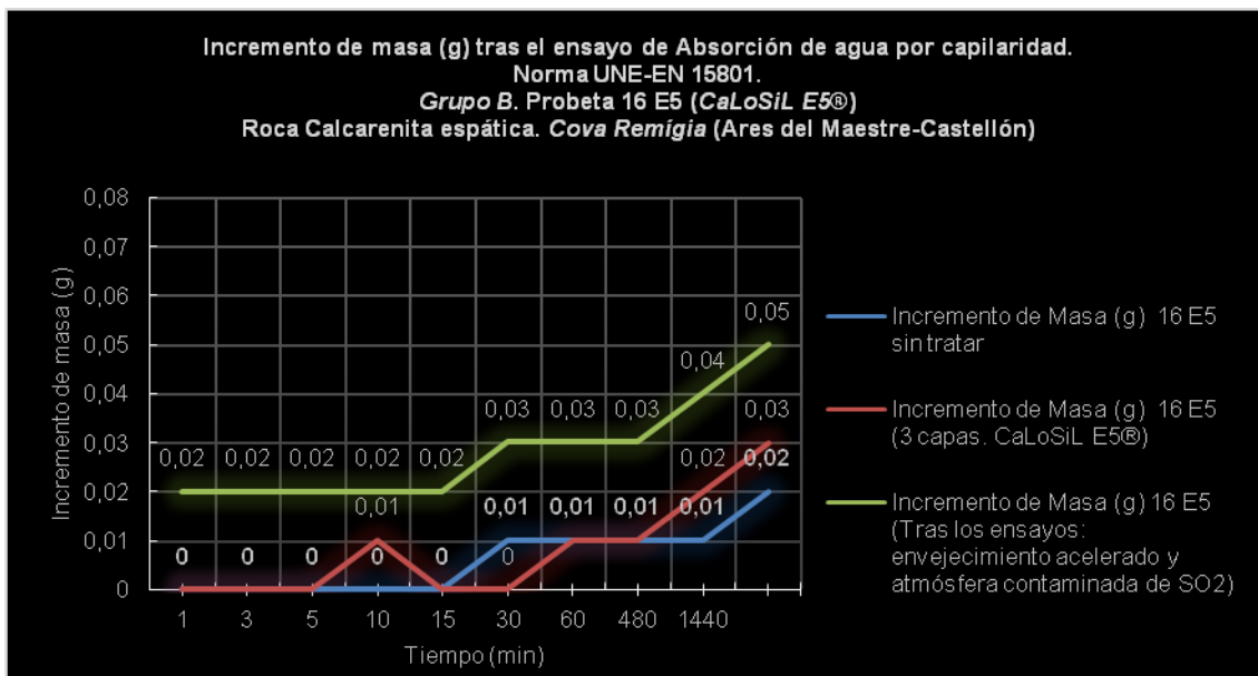
Gráfica 38. Datos comparativos del incremento de masa experimentado por la probeta 16 E5 (probeta perteneciente al grupo B (1), con la superficie sin pulir), con respecto a la masa inicial. Las valoraciones se han obtenido con el ensayo de absorción de agua por capilaridad (NORMA UNE-EN 15801), tras haber aplicado 3 capas de consolidante y haber sometido a la muestra a ensayos de envejecimiento acelerado y atmósfera contaminada por saturación de dióxido de azufre (SO 2 ).
