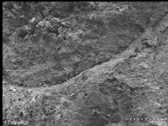
Figura 324. Probeta 10 NP5, tras los ciclos de envejecimiento acelerado y la exposición a atmósfera contaminada por saturación de \text{SO}_2 .
