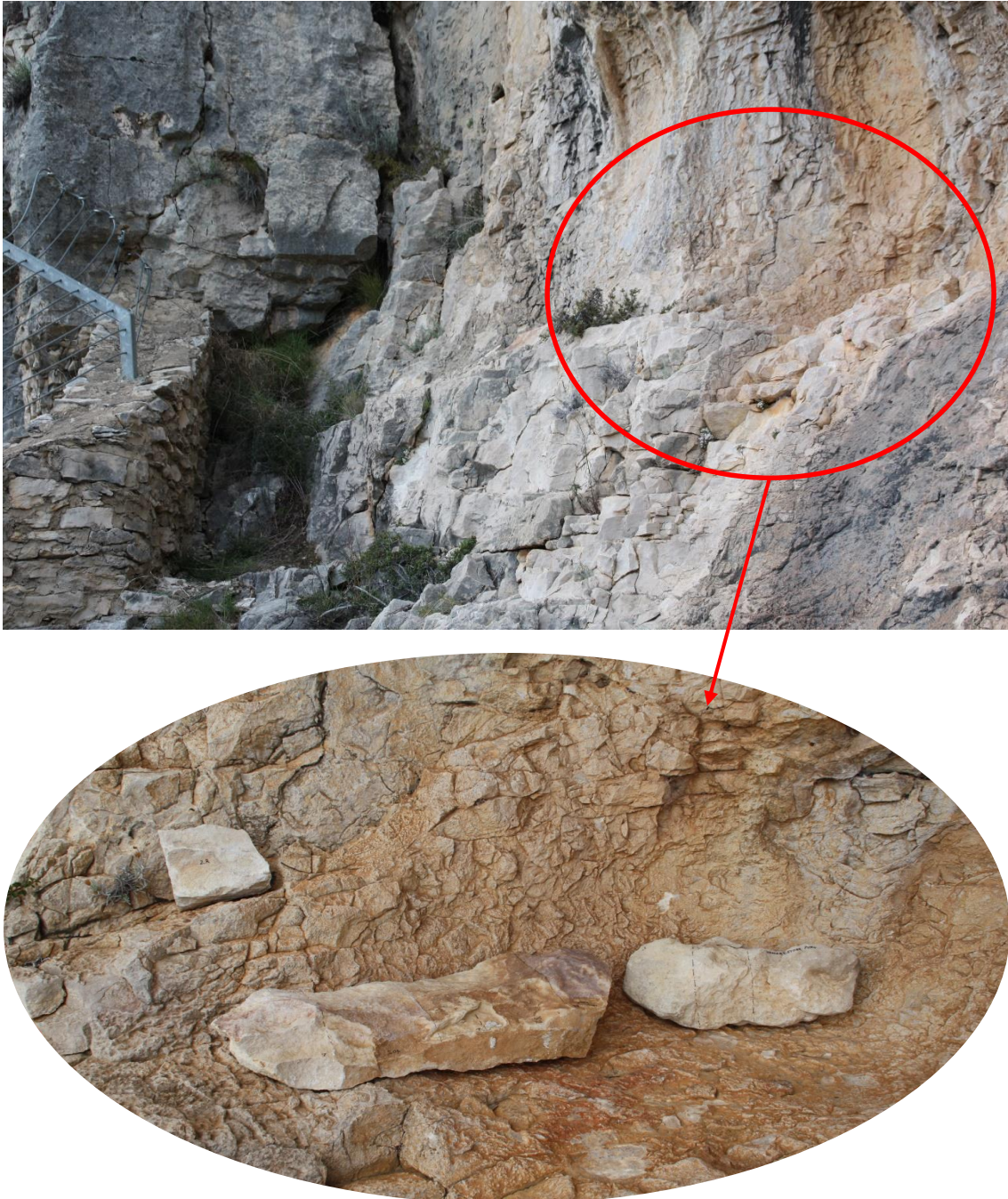
Figura 248. Ubicación de las probetas del grupo C (depositadas in situ ), destinadas al ensayo de envejecimiento natural.
