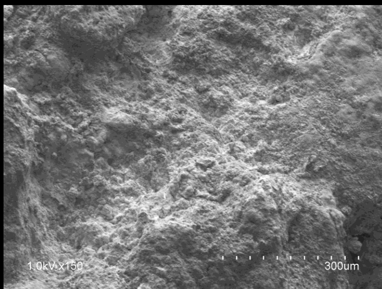
Figura 372. Superficie pétreo tratada con CaLoSiL E25 grey® . Tras los ciclos de envejecimiento acelerado.
