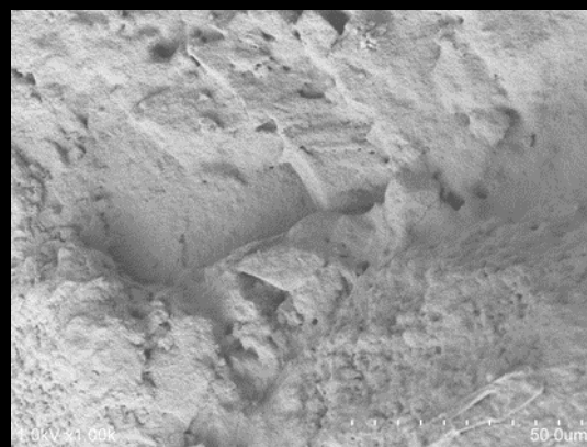
Figura 276. Probeta 4 E25g, con 3 capas de CaLoSiL E25 grey ®.
