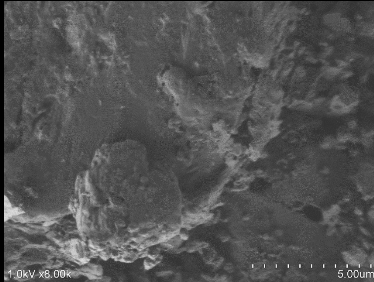
Figura 437. Detalle distribución superficial del Nanoestore® , probeta 28 N, con 3 capas de producto.
