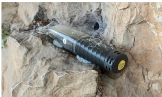
Figura 1. Modelo de DATALOGGER LOG32 utilizado en esta investigación para realizar mediciones de temperatura y humedad.
