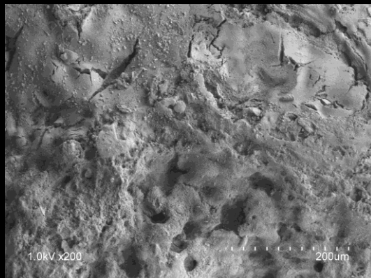
Figura 399. Superficie pétreo tratada con CaLoSiL IP5® , tras los ciclos de envejecimiento acelerado. Se observa la formación de grietas en las zonas donde la acumulación del consolidante es significativa.
