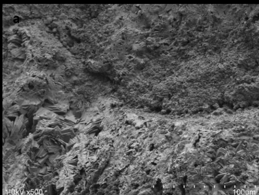
Figura 331. Probeta 10 NP5, tras los ciclos de envejecimiento acelerado y la exposición a atmósfera contaminada por saturación de \text{SO}_2 .
