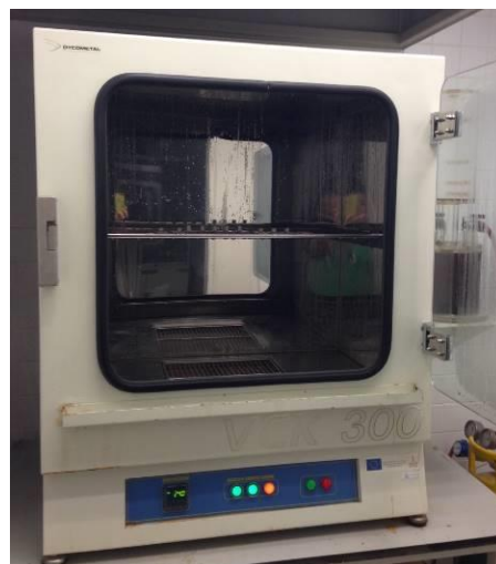
Figura 4. Cámara de corrosión modelo VCK300 de Dycometal , utilizada en esta investigación, (Laboratorio de análisis físico-químicos). Instituto Universitario de Investigación de la Universitat Politècnica de València de la UPV.
