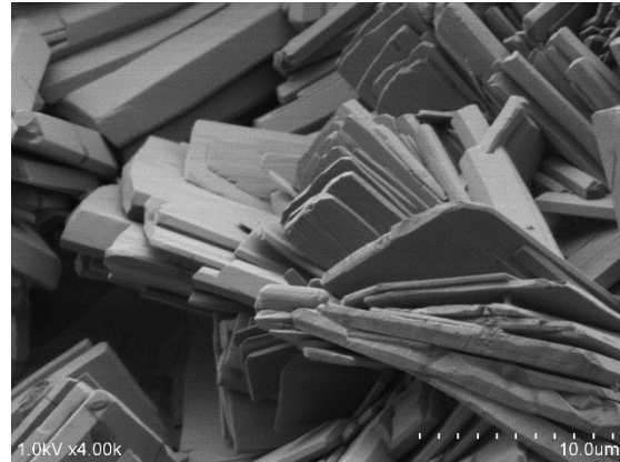
Figura 252. Imagen SEM. Probeta 10 NP5 (CaLoSiL NP5®. Grupo A con la superficie pulida), tras los ciclos de contaminación atmosférica con atmósfera saturada con SO 2 .
