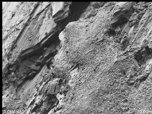
Figura 326. Detalle del CaLoSiL NP5® , sobre la Probeta 10 NP5, con 3 capas de producto.
