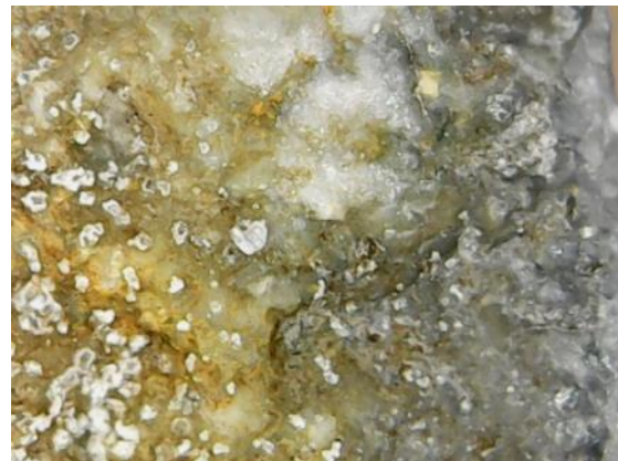
Figura 250. Imagen microscopio portátil DigiMicroscope USB reflecta . Probeta 28 N ( Nanorestore ®. Grupo B, sin pulir), tras los ciclos de contaminación atmosférica con atmósfera saturada con SO 2 .
