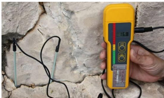
Figura 2. Modelo de higrómetro de contacto NEURTREK INSTRUMENTS utilizado en esta investigación para realizar mediciones de temperatura y humedad en el soporte.
