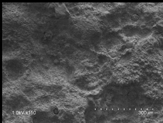
Figura 415. Superficie pétreo tratada con CaLoSiL NP50 , tras los ciclos de envejecimiento acelerado.
