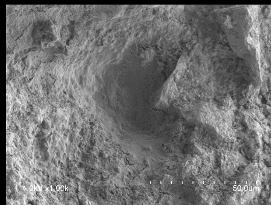
Figura 419. Superficie pétreo tratada con CaLoSiL NP50 , tras los ciclos de envejecimiento acelerado. Se observa la formación de microfisuras y acumulación del consolidante en zonas cóncavas, creando un estrato filmógeno uniforme.
