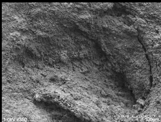
Figura 281. Probeta 4 E25g, tras los ciclos de envejecimiento acelerado y exposición a atmósfera contaminada por saturación de SO 2 .
