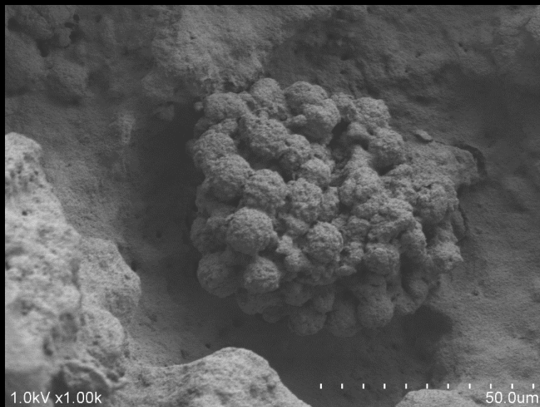
Figura 368. Detalle de la Probeta 19 E25g, con 3 capas de CaLoSiL E25 grey® . Se observa la formación de fisuras alrededor del microorganismo.
