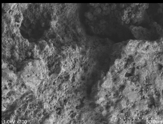
Figura 351. Detalle de la Probeta 16 E5, con 2 capas de CaLoSiL E5 ®.
