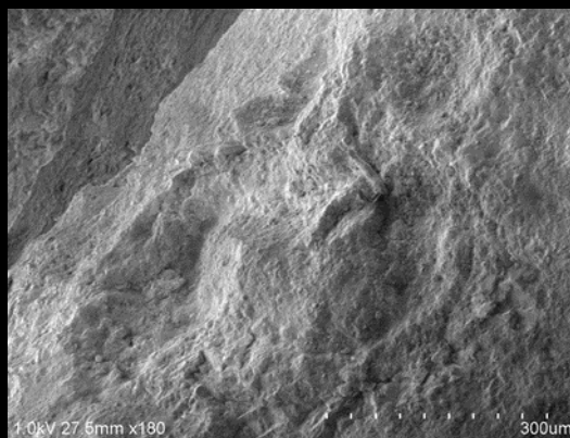
Figura 292. Imagen Probeta 7 IP5, con 2 capas de CaLoSiL IP5®
