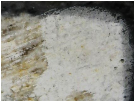
Figura 249. Imagen microscopio portátil DigiMicroscope USB reflecta . Probeta 13 N ( Nanorestore ®. Grupo A, con la superficie pulida), tras los ciclos de contaminación atmosférica con atmósfera saturada con SO 2
