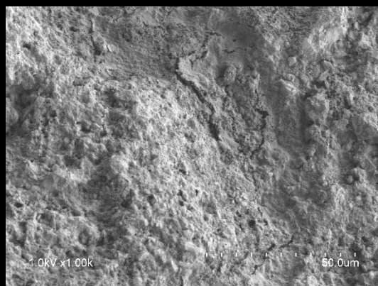
Figura 418. Superficie pétreo tratada con CaLoSiL NP50 , tras los ciclos de envejecimiento acelerado. Se observa la formación de microfisuras.
