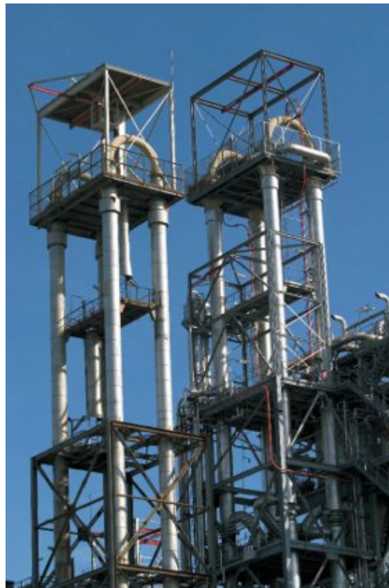
Figura 3.2 Reactor en lazo del proceso Philips de obtención del PEAD
