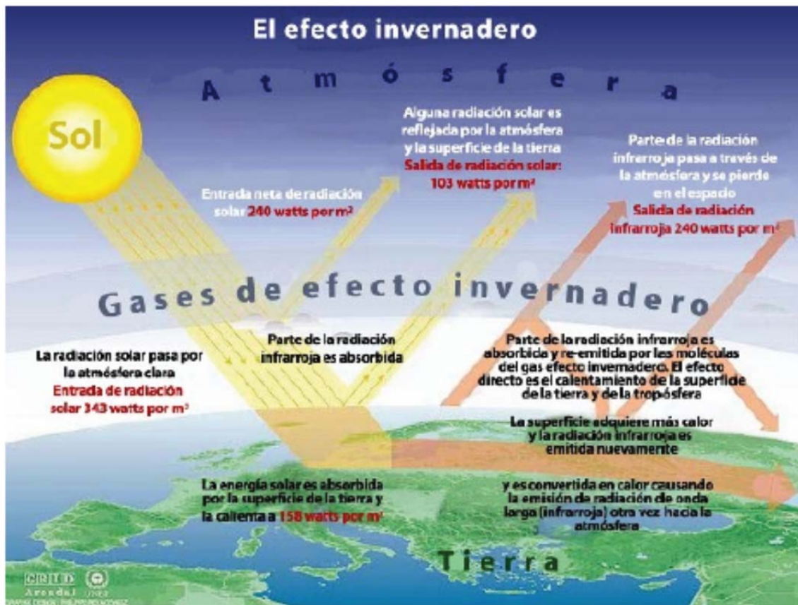
Figura 12. Esquema general de la forma en que se produce el efecto invernadero
