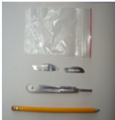
85. Materiales utilizados para la toma de muestras: bolsas de recolección, bisturí de corte y lápiz de mina negra.(Fotografía Rossana Llanos).
